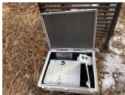
< 노면온도 측정용 아스팔트 시편 설치 및 측정 장비 콘솔 >
