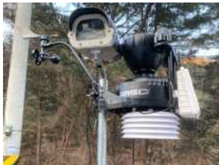
< 기상관측장비와 카메라 및 설치 현장 >
