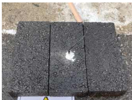
< 노면온도 측정용 아스팔트 시편 설치 및 측정 장비 콘솔 >
