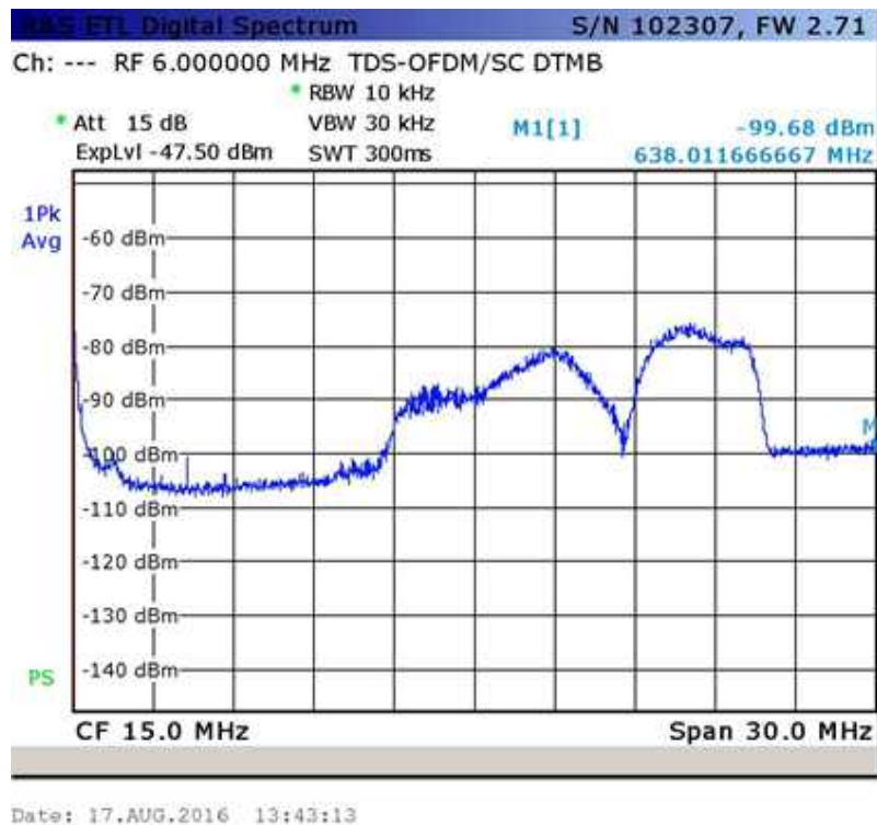
그림 119 차폐선 적용하지 않은 혼선 신호의 주파수 스펙트럼
