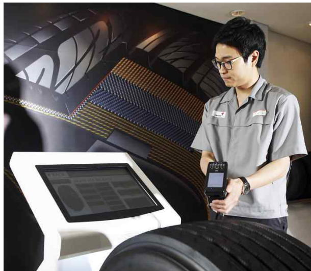
[그림 28] 타이어에 부착한 RFID를 통한 이력정보 확인
