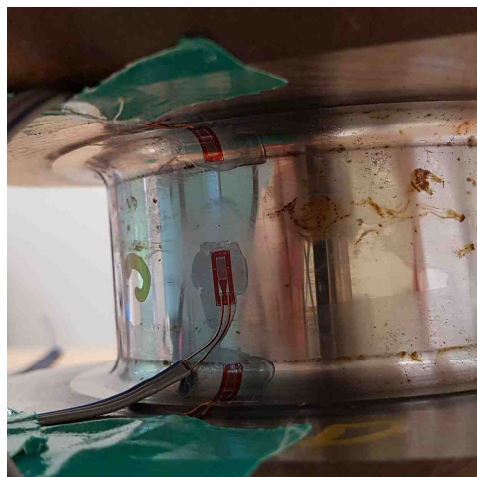
[Strain gage 설치 사진]
