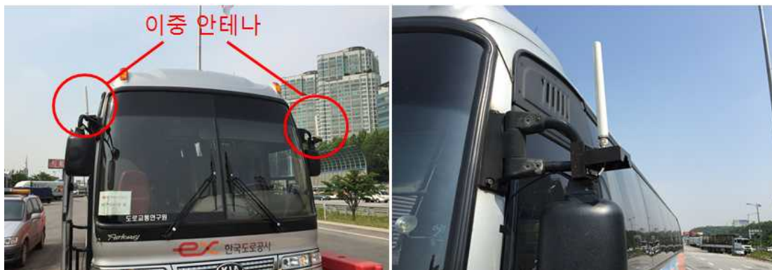
<그림 52> 대형버스 이중 안테나 설치 변경
