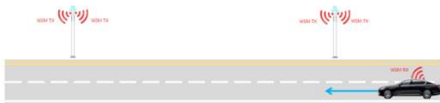
<그림 92> 도로환경 통신영역 성능 시험 시나리오
