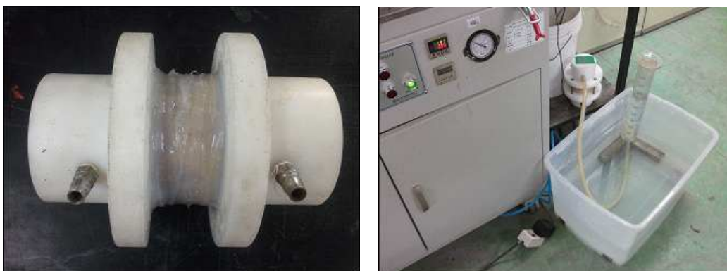
그림 5-14. 투기계수 시험(Darcy's law) 모습
