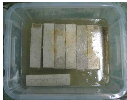
b) 5% \text{H}_2\text{SO}_4 용액 침지
