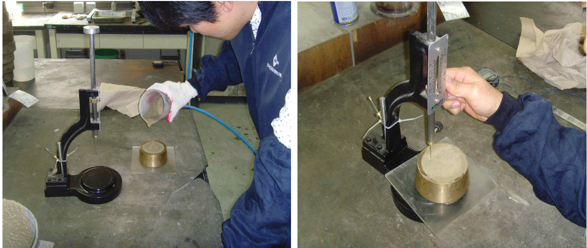
그림 3-23. 응결시간 측정 모습
