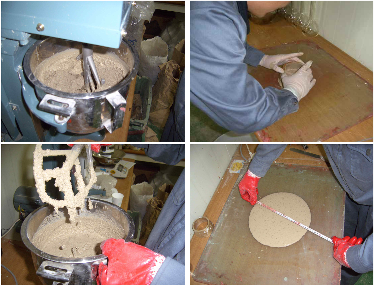
그림 3-19. 유동성 확보 시험 과정
