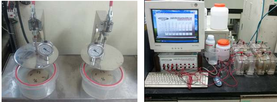
그림 5-18. 염화이온 침투 저항성 시험
