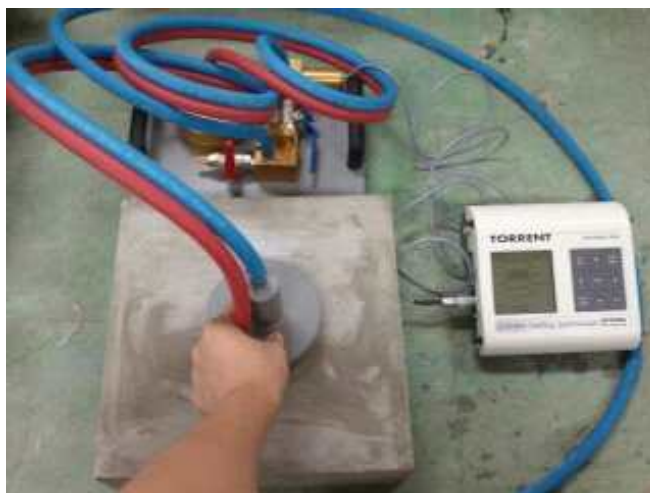
그림 5-15. 투기계수 시험(Torrent's law) 모습
