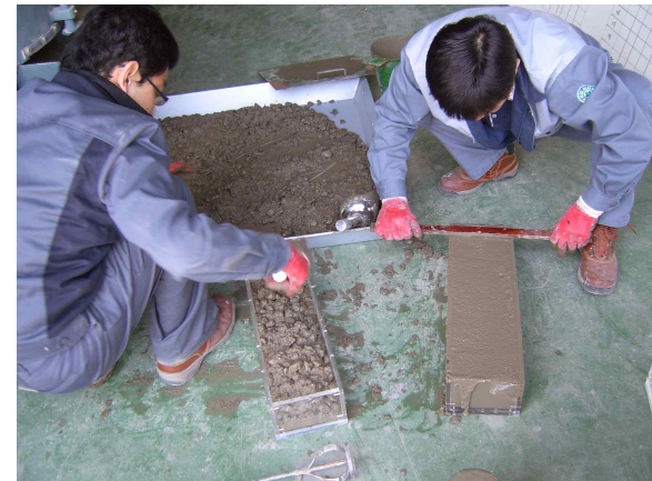
그림 3-37. 복공콘크리트 시험 및 제작 사진
