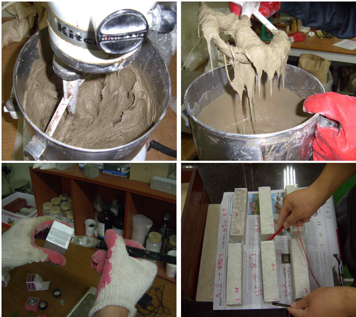
그림 5-40. 접지저항 저감제 시험 모습 및 전도성 측정 모습
