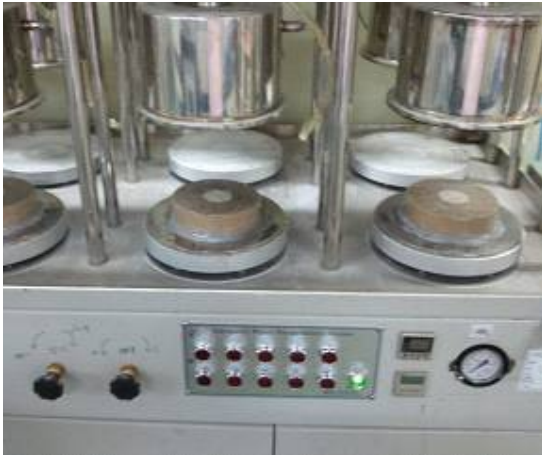
그림 5-10. 투수 시험 모습
