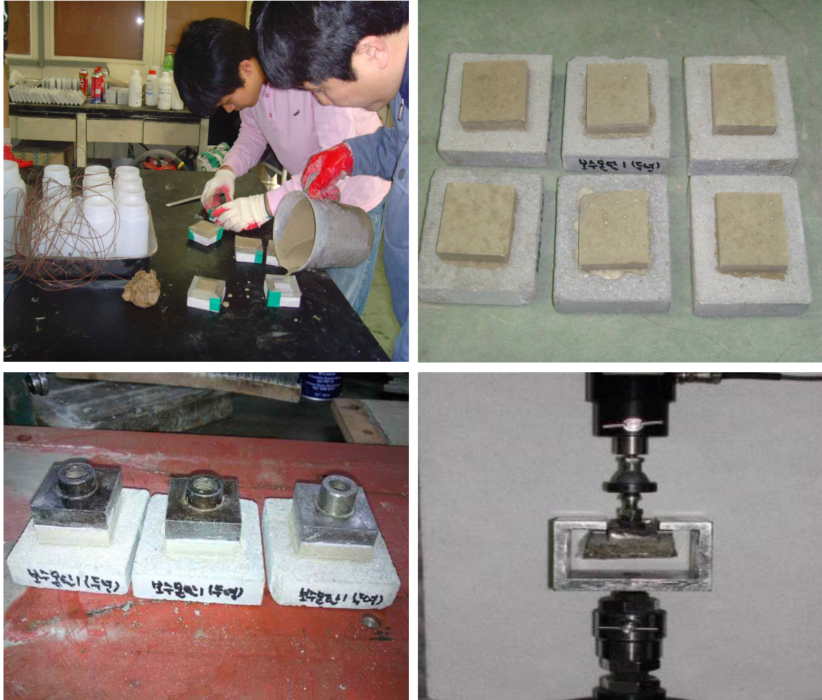
그림 3-42. 부착강도 시험체 제작 및 시험 모습
