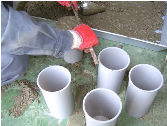
그림 3-37. 복공콘크리트 시험 및 제작 사진
