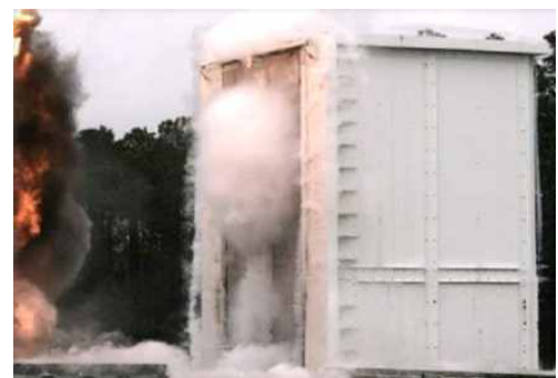
[Concrete Sandwich Panel 방폭성능 실험 장면]
