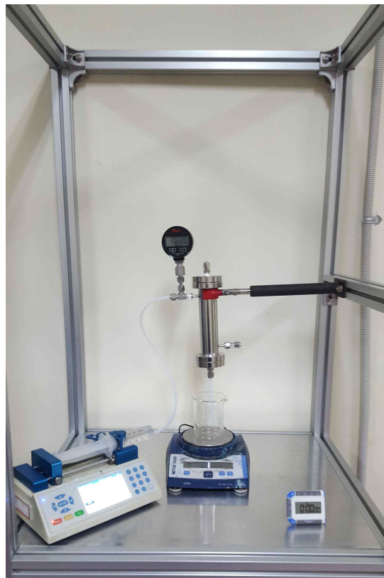
[그림 99] 수투과도 측정 장치
