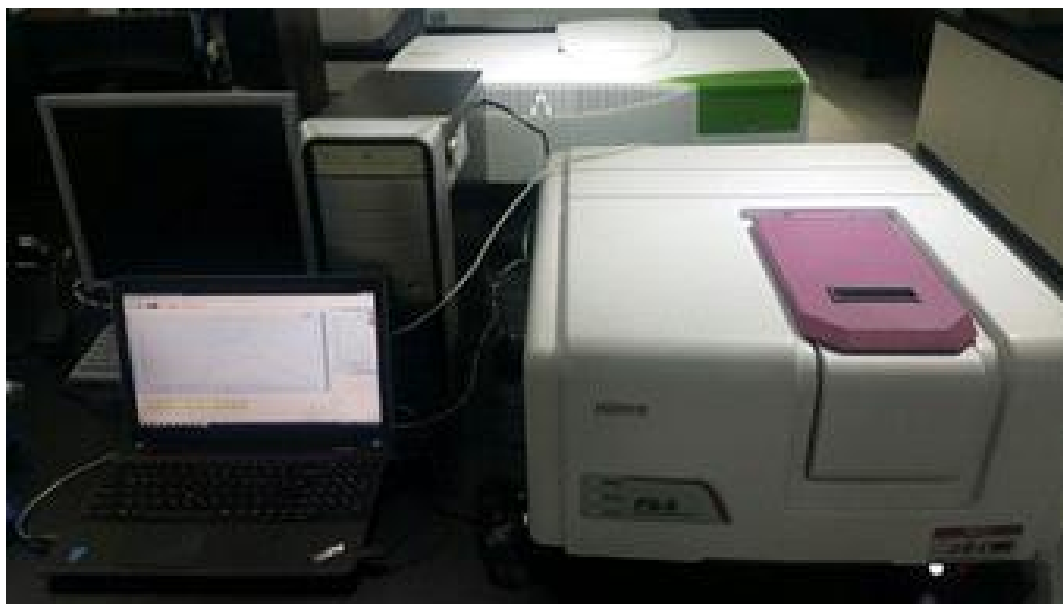
[그림 41] PL 측정 장치 (FS-2 Fluorescence Spectrometer. SCINCO, Korea)
