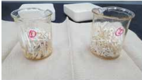
TBOT를 전구체로 하여 제조한 \text{TiO}_2 졸을 이용하여 10분간 딥코팅 후 오븐에서 건조
