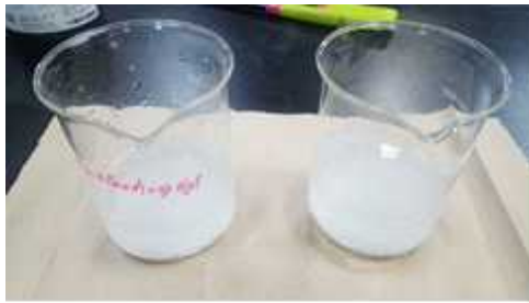
0.01M 농도로 Silica based binder와 Hexane을 혼합
