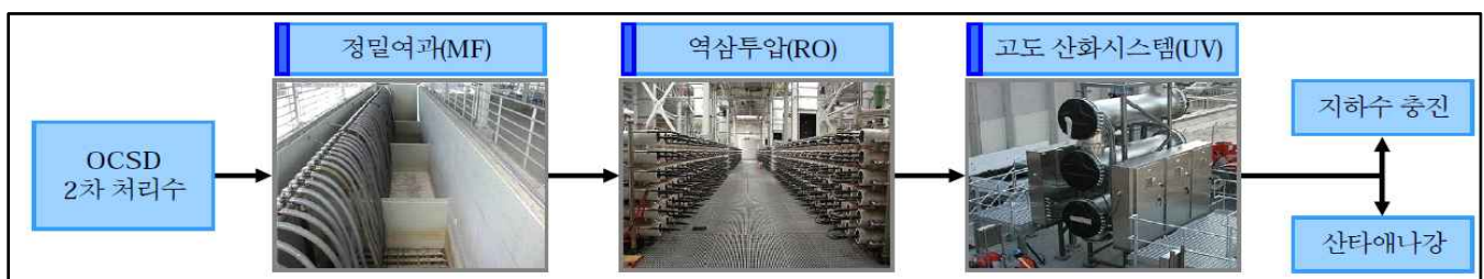
[그림 15] 지하수 보충 시스템(GWR) 공정도
