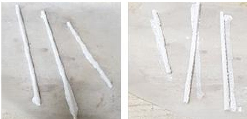
[그림 33] \text{TiO}_2 코팅 전(좌), 코팅 후(우)
