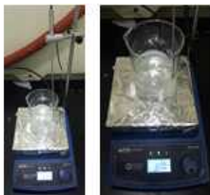
[그림 31] \text{TiO}_2 제조 실험 수행 내용 (졸-겔법, 시작물질 TBOT)
