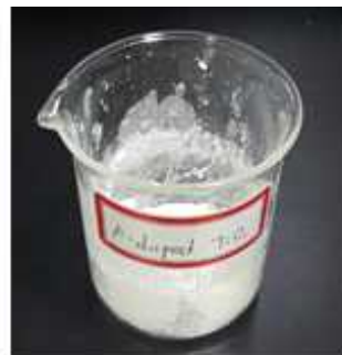
[그림 44] S-doped \text{TiO}_2 제조
