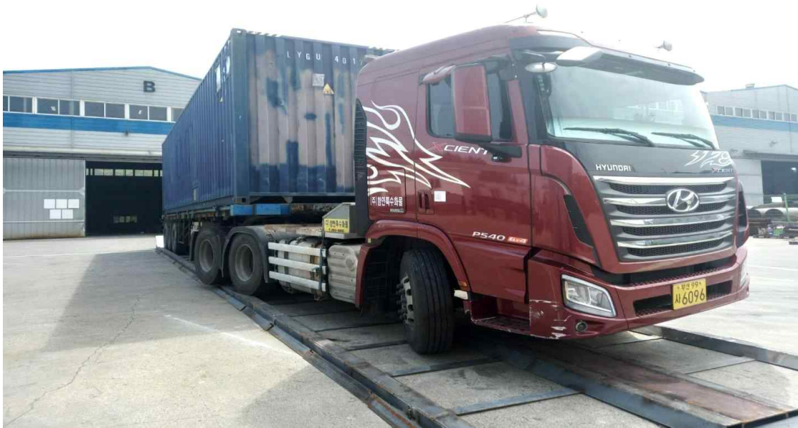
4) 피기백 화차 트레이러 상차 시험 완료 점검
