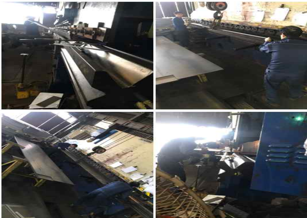
[단품제작 1 - 철판 절곡 및 천공 작업]
