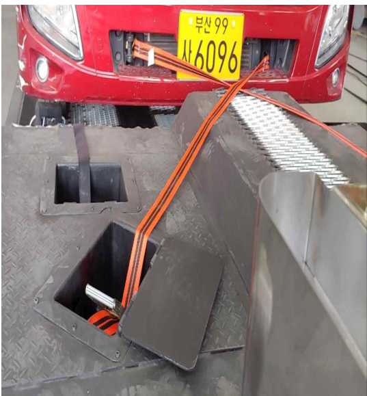
[ 피기백 화차 결박 장치 체결 상태 - 좌측 ]
