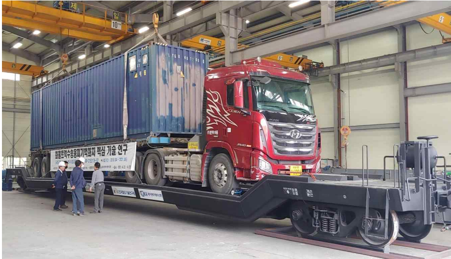
[ 컨테이너 트레일러 상차 시험 최종 상태 확인 ]
