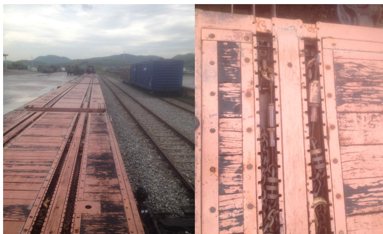
그림 40 미군 사유 화차 결박장치 모습
