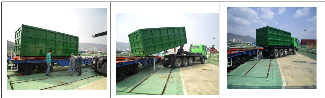
그림 136. 무동력 회전장치 환적시스템을 이용한 하화 전경
