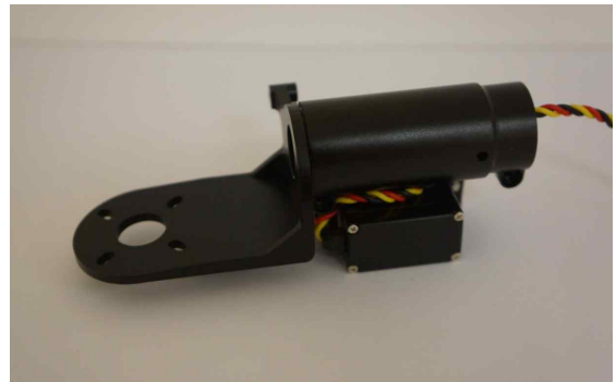
그림 58 기체 전방 모터 마운트(좌), 후방 모터 마운트(우) 제작 사진
