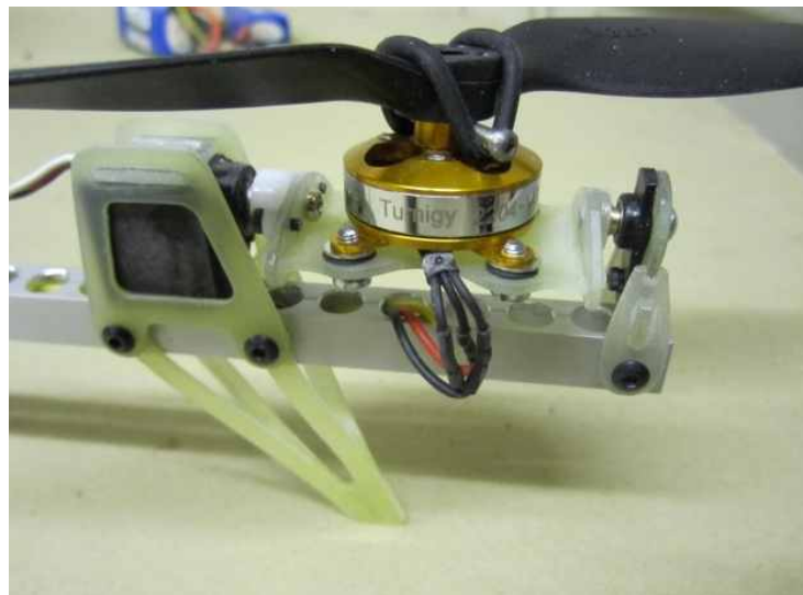
그림 15 Tail Motor Arm 조종 액추에이터(예시)
