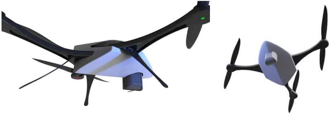
그림 6 접이식 랜딩기어 개념 설계(Retractable type)
