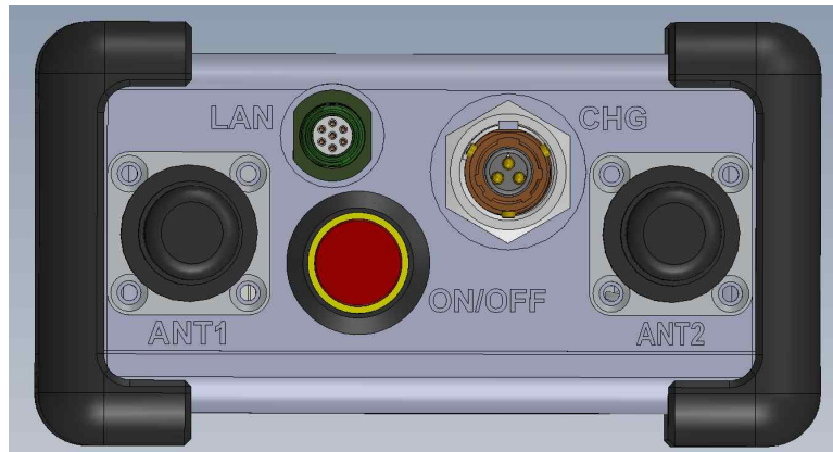
그림 62 GDT 상단(외부 연결 커넥터 및 안테나 배치)
