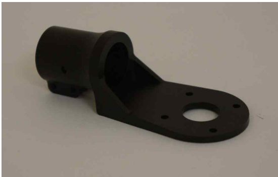
그림 58 기체 전방 모터 마운트(좌), 후방 모터 마운트(우) 제작 사진
