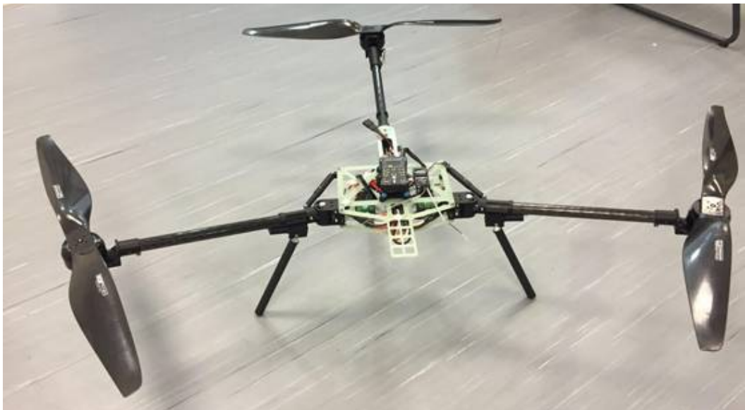
그림 29 Puppy3 제작 완료(FCC 보드 및 주변 구성품 탑재)
