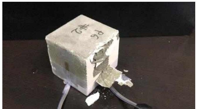
<P7(유성페인트) 압축하중시험 종료 후 시편상태>
