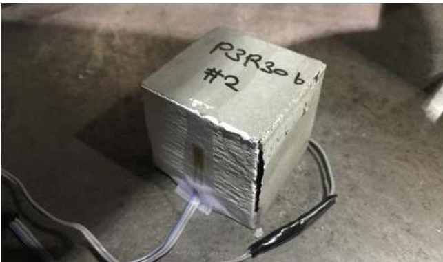
<P3(수성페인트) 압축하중시험 종료 후 시편상태>
