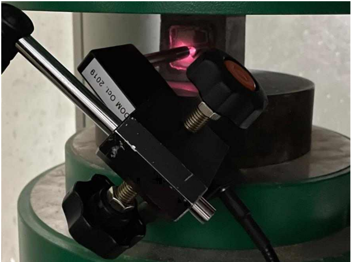
<설치된 압축하중시편(제안방법 2) 및 스펙트럼 계측용 프로브 (785nm 레이저 조사 中)>
