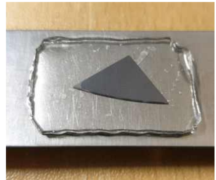
<휨하중실험용 시편 : Silicon wafer + 에폭시 레진>
