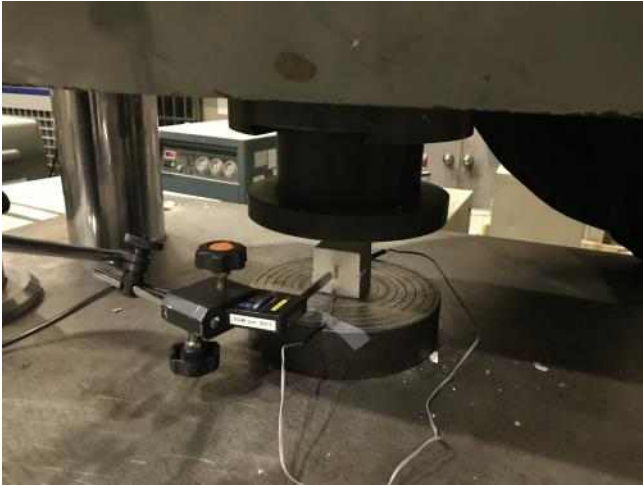
(c) 변형률계가 설치된 페인트 시편
