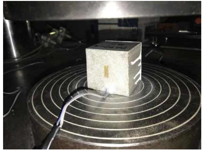
(b) 변형률계 설치-모르터 표면
