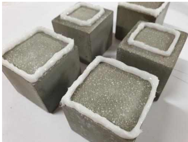
<실리콘 실란트(Silicone sealant)가 도포된 시멘트 모르터 시편>
