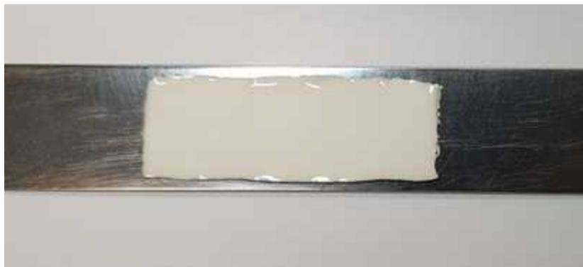
<휨하중실험용 시편 : Titanium dioxide powder + 에폭시 레진>
