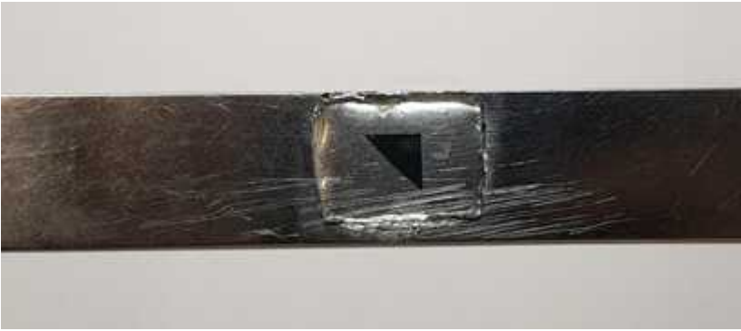
<휨하중실험용 시편 : Silicon wafer + 에폭시 레진>
