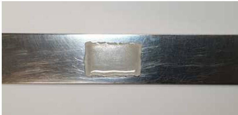
<휨하중실험용 시편 : Alumina powder + 에폭시 레진>
