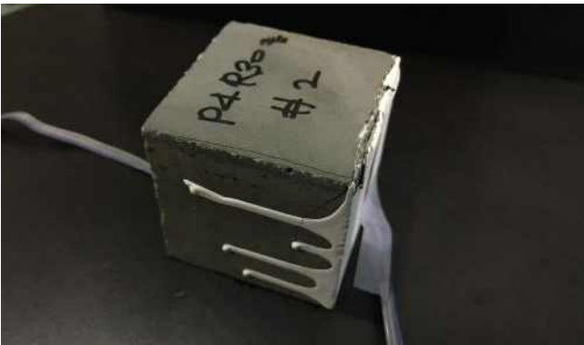
<P5(유성페인트) 압축하중시험 종료 후 시편상태>
