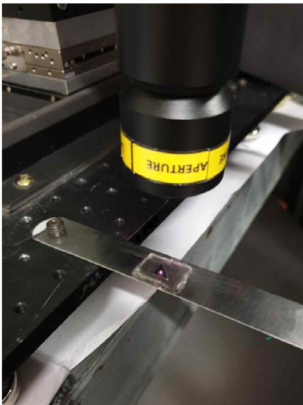
(a) 줌렌즈를 이용한 응력 측정기술
