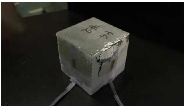
<P7(유성페인트) 압축하중시험 종료 후 시편상태>
