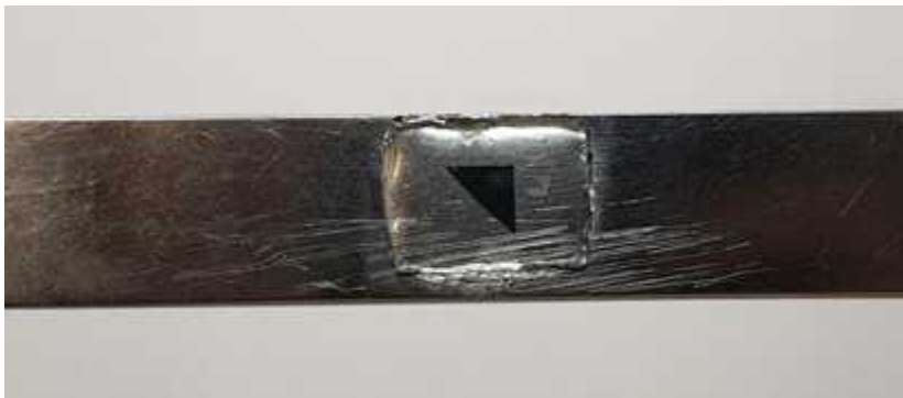
<휨하중실험용 시편 : Silicon wafer + 에폭시 레진>
