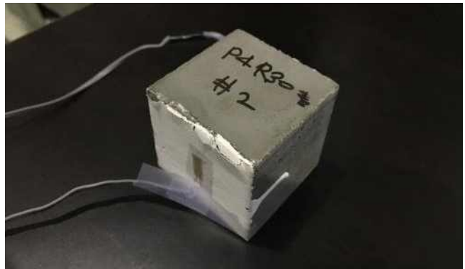
<P5(유성페인트) 압축하중시험 종료 후 시편상태>
