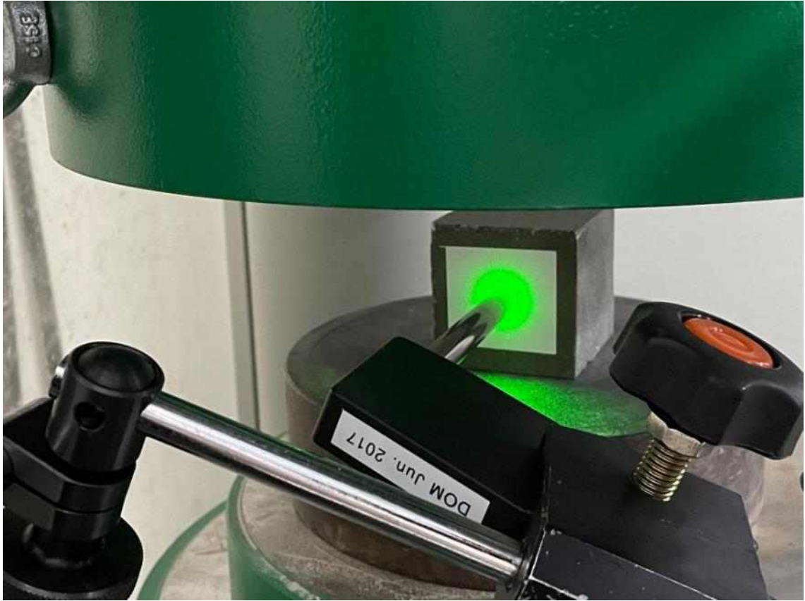
<설치된 압축하중시편(제안방법 1) 및 스펙트럼 계측용 프로브 (532nm 레이저 조사 中)>
