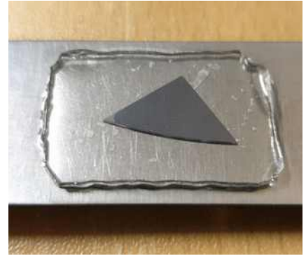
<휨하중실험용 시편 : Silicon wafer + 에폭시 레진>
