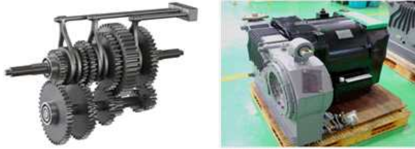
그림 2-가-12 기계식 기어의 종류 중 자동차 수동 변속기(좌) 및 철도차량용 감속기(우)
