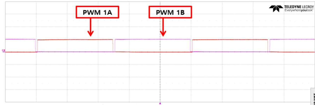
그림 2-가-69 오실로스코프를 이용한 10kHz의 PWM 신호 출력파형 (DeadTime Gap : 1.3 usec)
