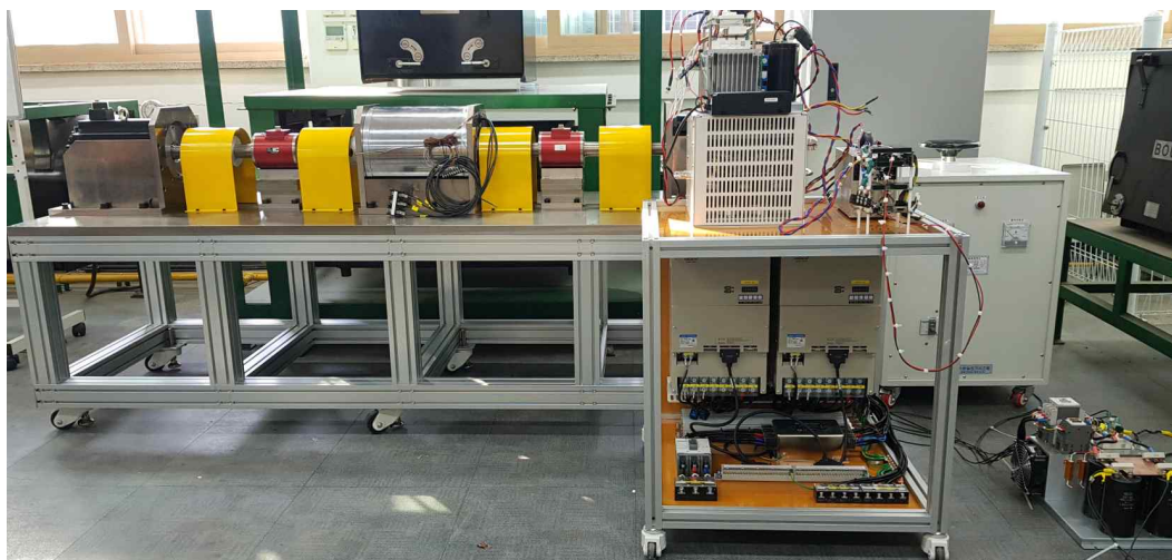
그림 2-가-85 서보모터 드라이브를 포함한 최종 M-G set
