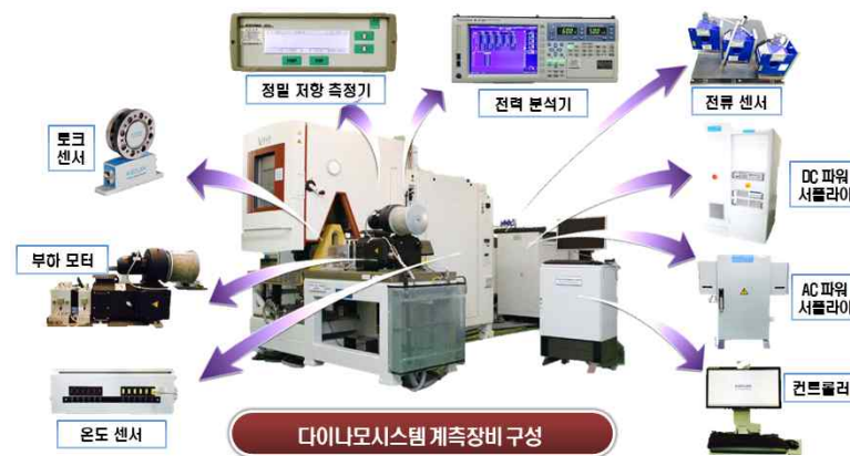
그림 2-가-77 일반적인 다이남 시스템 장비 구성
