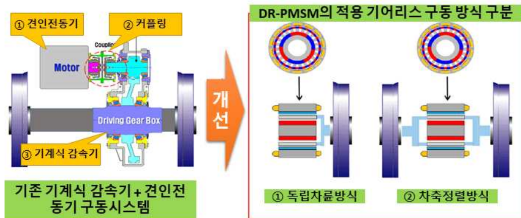
그림 1-나-3 DR-PMSM의 적용을 위한 철도차량용 차륜과의 조합 방식 분류
