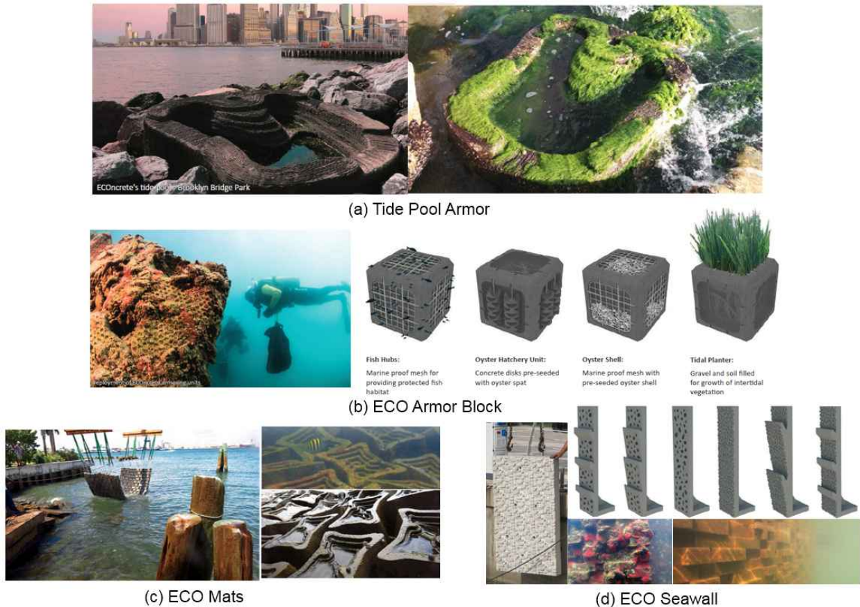
[그림 4.44] 이스라엘 E.ONcrete社의 친환경 생물공생형 해양 콘크리트 구조물
