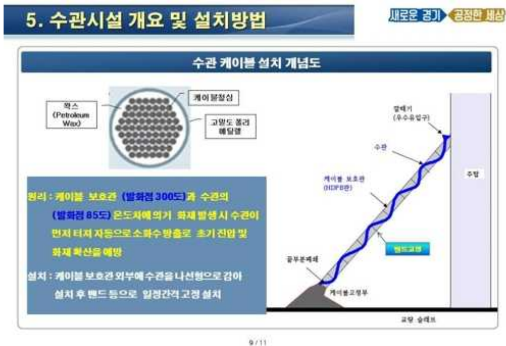
[그림 4.15] 케이블의 화재를 방지하는 수관 장치 설치 및 화재방지법
