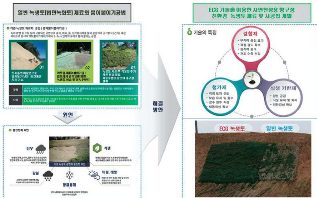
[그림 4.30] ECG기술을 이용한 비탈면 안정용 항구성 친환경 녹생토 재료 및 시공법 개발
