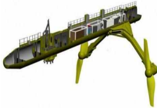
[그림 4.26] STP社가 개발한 부유식 조력발전장치 SR2000
