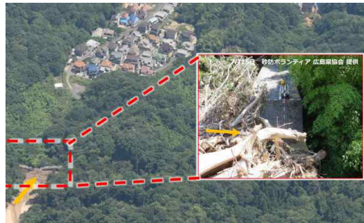
[그림 2.3] 기존의 제방 시설에 투과형 제방 등의 정비 사례
