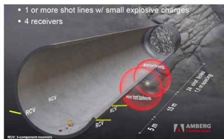
(b) TSP을 통한 터널전방 지반조건 탐사기법
