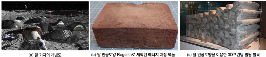
[그림 4.54] 달 기지 건설을 위한 에너지 저장 인공토양 및 벽돌 개발
