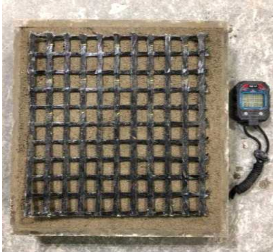
급결제 사용 23분 후 시공 결과
