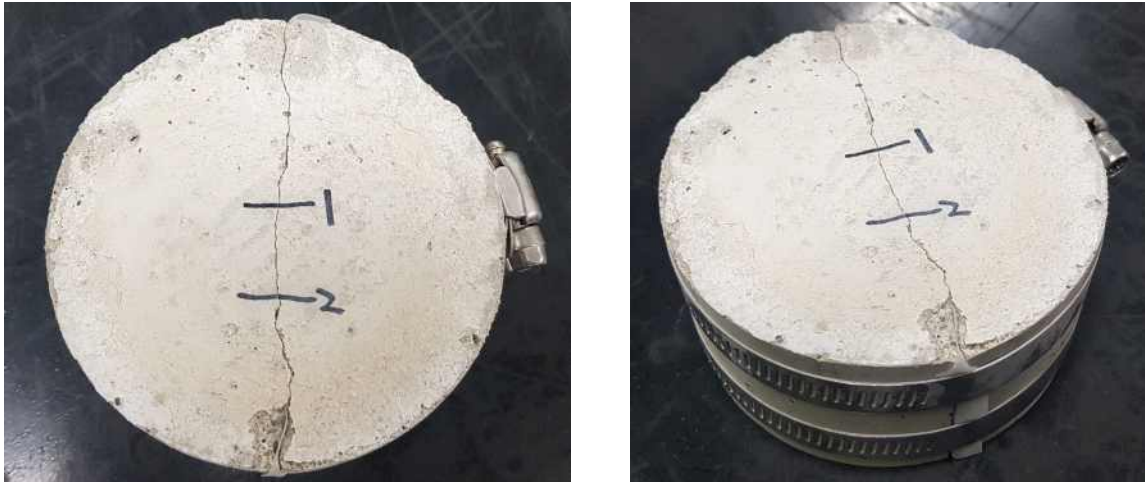
그림 2-51. 균열 폭 0.25 mm로 조절된 투수 시험용 시편
