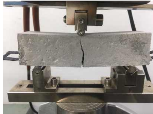
균열 발생 시편
