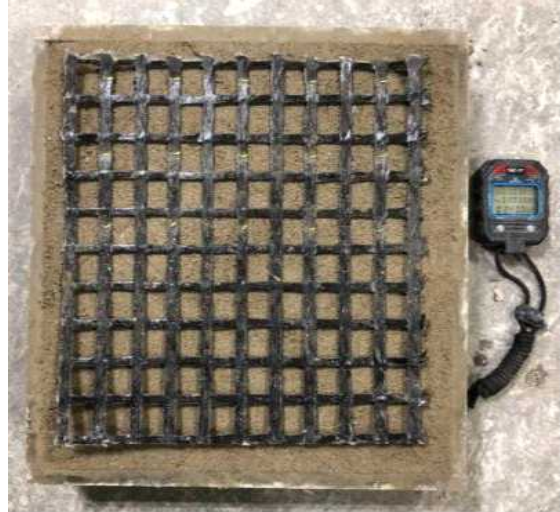
급결제 사용 24분 후 시공 결과
