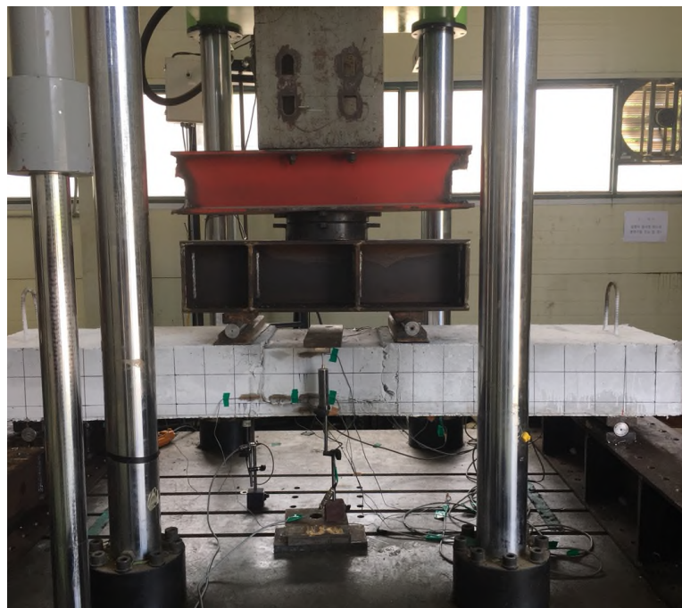
[그림 36] 프리캐스트 연결부 거동분석 요소시험 전경
