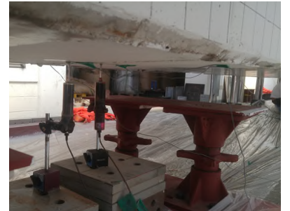
Strain Gauges 및 계측장비 설치
