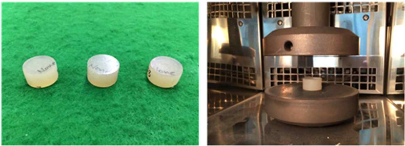
그림 1. 폴리우레탄의 압축 크리프 시편 및 시험 전경
