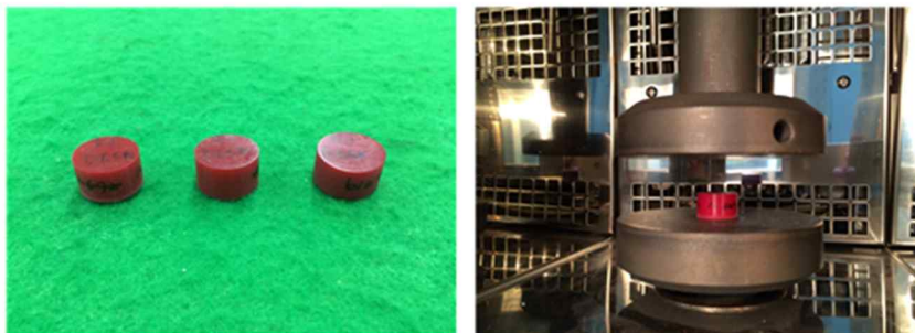
그림 3. 압축 크리프 시편 및 시험 전경
