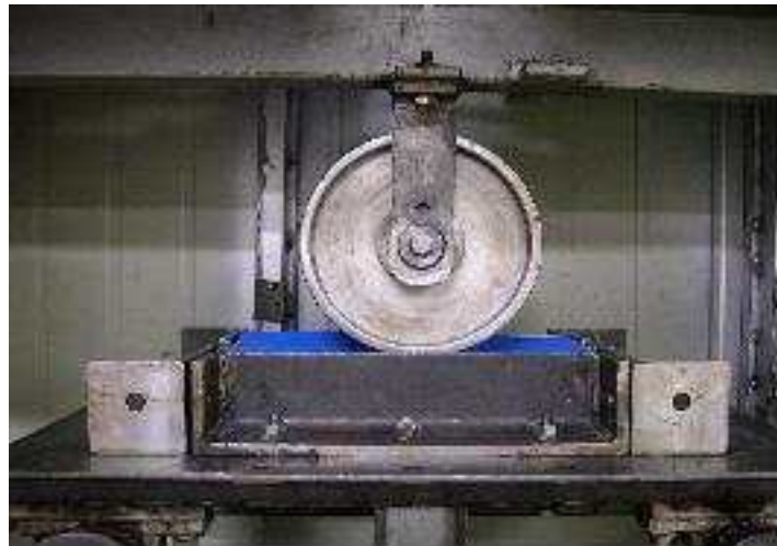
<그림 70> Wheel Tracking 시험
