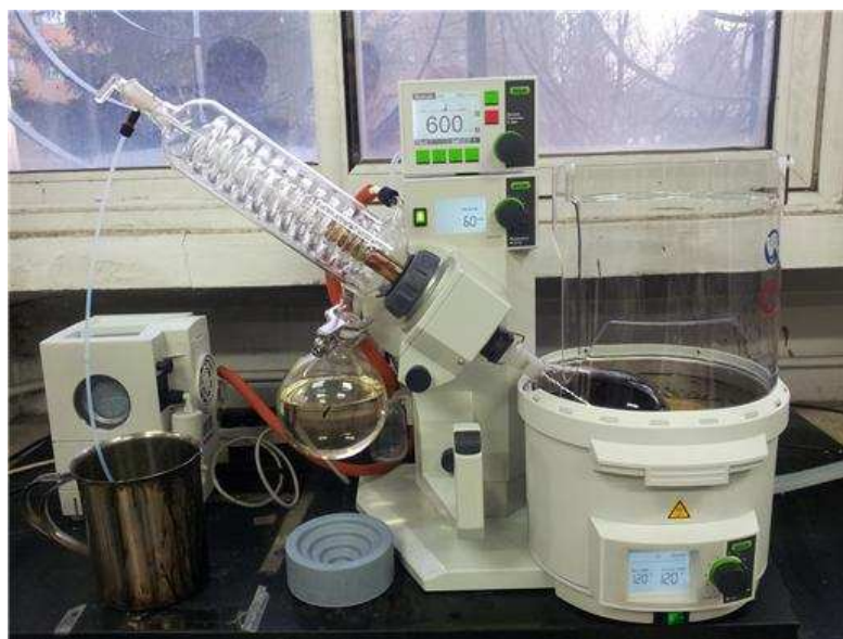
<그림 44> Rotavapor recovery 장비
