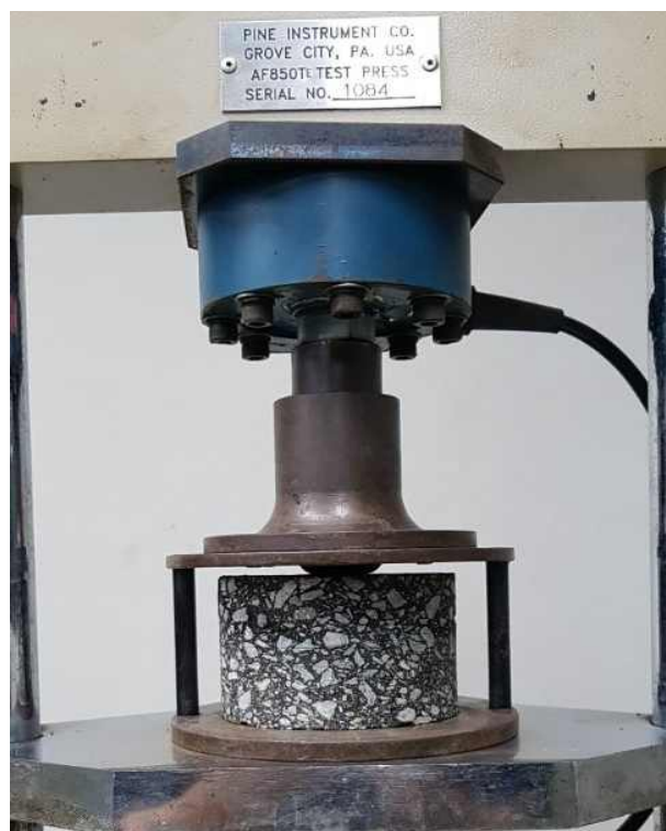
<그림 66> Kim Test에 의한 변형강도( S_D ) 측정
