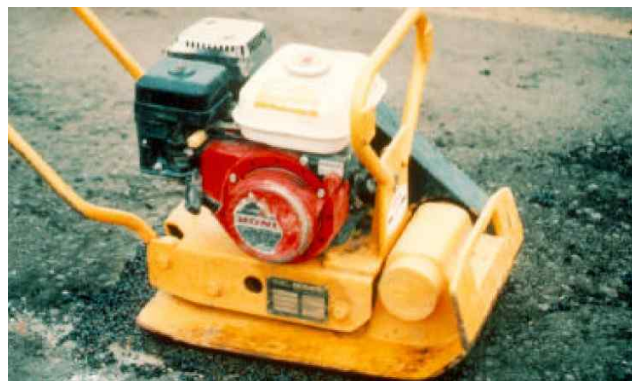
〈그림 9〉 휴대용 다짐장비를 이용한 다짐
