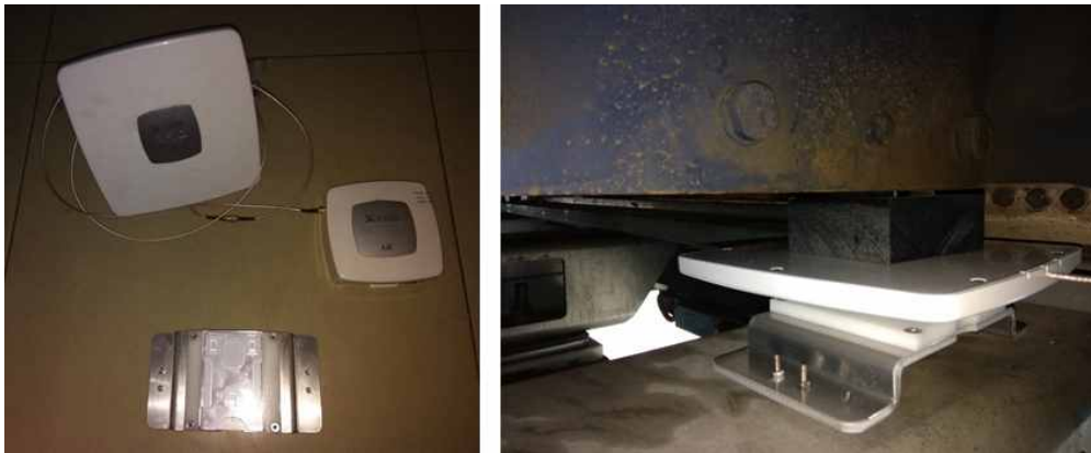
<차량 위치정보를 위한 RFID 시스템 및 차량 설치 형태>
