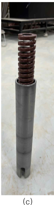
그림 69. (a) 결합 방식 도식도, (b) 제작 말뚝, (c~e) 말뚝 결합 과정: (c) 하부 말뚝에 지반 변형 대응 부재 삽입, (d) 상부 말뚝 결합, (e) 슬리브 결합
