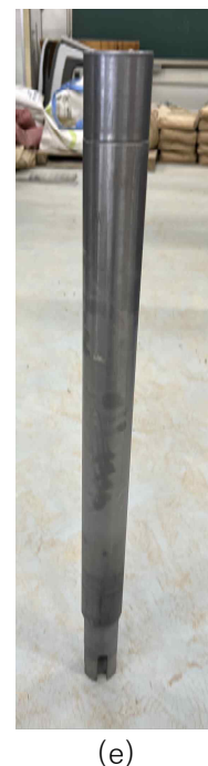
그림 69. (a) 결합 방식 도식도, (b) 제작 말뚝, (c~e) 말뚝 결합 과정: (c) 하부 말뚝에 지반 변형 대응 부재 삽입, (d) 상부 말뚝 결합, (e) 슬리브 결합
