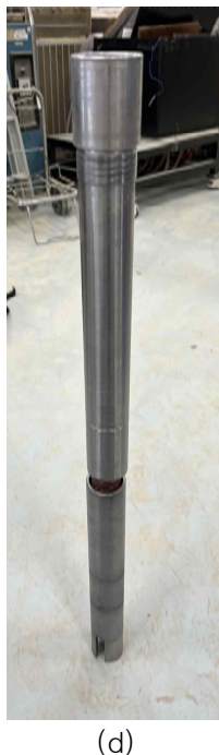
그림 69. (a) 결합 방식 도식도, (b) 제작 말뚝, (c~e) 말뚝 결합 과정: (c) 하부 말뚝에 지반 변형 대응 부재 삽입, (d) 상부 말뚝 결합, (e) 슬리브 결합
