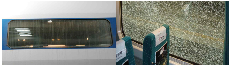
그림 6 일반유리창 타격흔적(좌) 및 비상유리창 파손(우)
