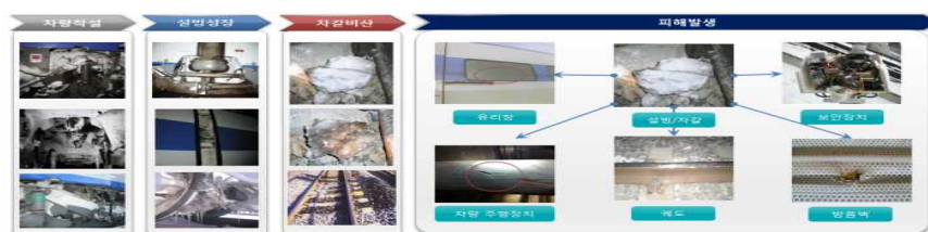
그림 5 고속선 설빙피해 발생 메카니즘
