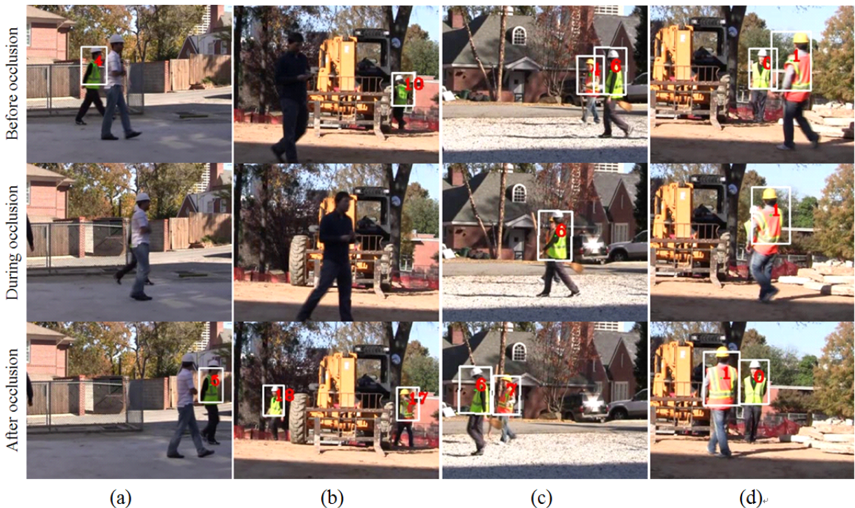
그림 2-24. Occlusion 처리 과정: OC1 (a, b), OC2 (c, d)
