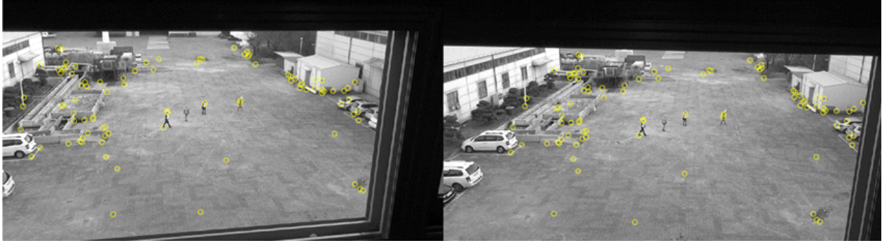
그림 2-36. SIFT를 이용한 두 영상에서의 동일 특징점 추출
