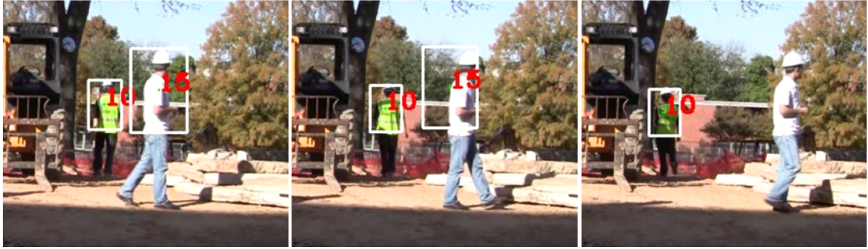
그림 2-22. 안전조끼 미착용자인 15번 개체(FP)의 탐지(좌측 그림), FP의 추적 과정 (중간 그림), FP 추적의 자동 종료 (우측 그림)
