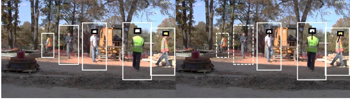
그림 2-8. 건설인력 및 안전모 탐지 결과
