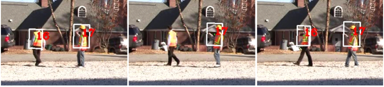
그림 2-23. 16번 개체의 추적 (좌측 그림), 추적과정의 잘못된 자동 종료 (중간 그림), 다시 탐지되어 같은 번호를 부여받은 16번 개체 (우측 그림)
