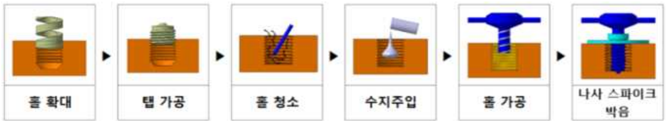
< 나사스파이크 홀 손상시 보수 방법 >
