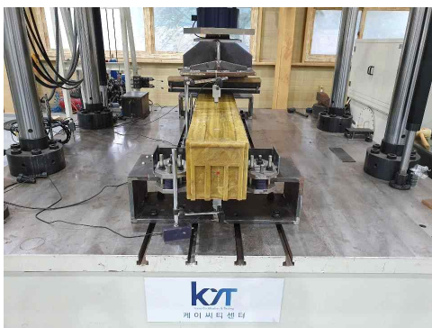
(a) 수직 재하 시험 (침목-거더 고정장치)
