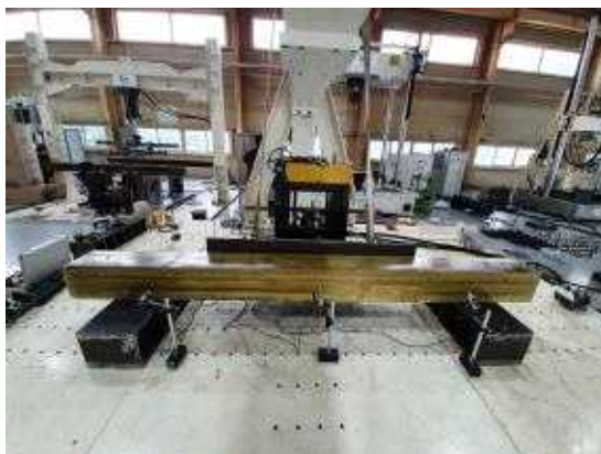
(a) 침목 1개 단위 시험 (체결장치 X)
