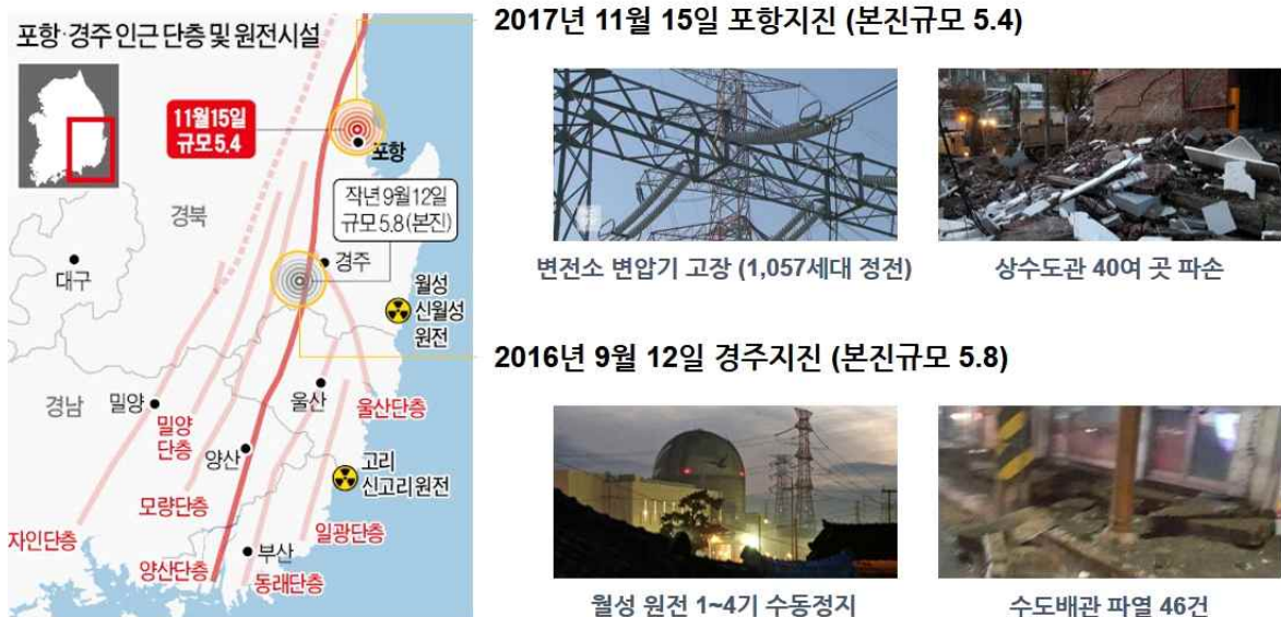
[그림 1] 경주, 포항지진 당시 사회기반시설 피해 사례
