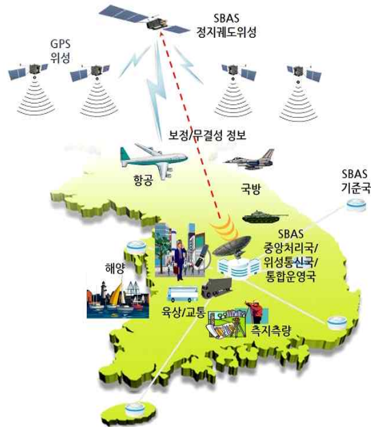
그림 7. 대한민국 SBAS 시스템 KASS 개념도 (출처:항공우주연구원)
