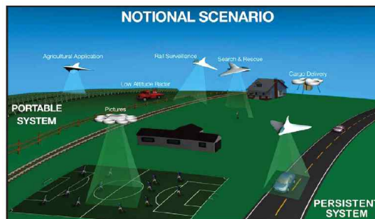
그림 54 NASA의 UTM 시스템 개념도
