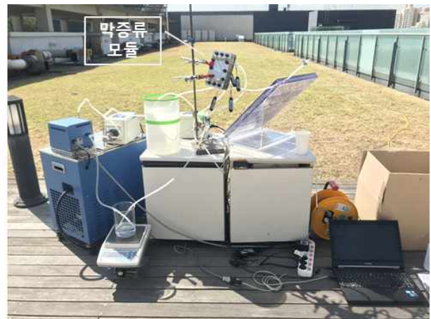
<그림 2.69. 태양열 집열기가 결합된 소규모 막증류 시스템>
