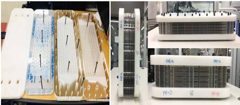
<그림 2.39. 파일럿 플랜트 용 막증류 모듈 설계도>
