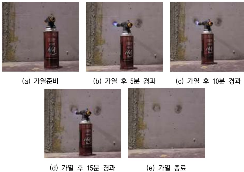
그림 4.7 가열에 따른 실험체의 외관변화
