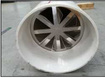
[제작] 회전판 배관 설치
