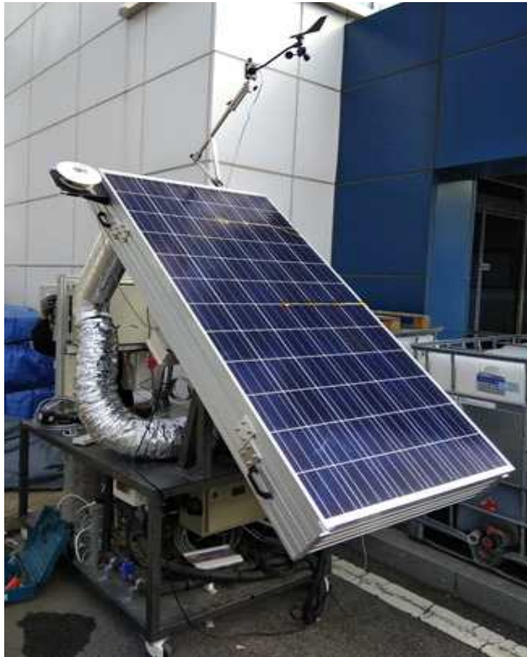
[그림 3-10] 태양열광(PVT) 시작품 성능측정 장치
