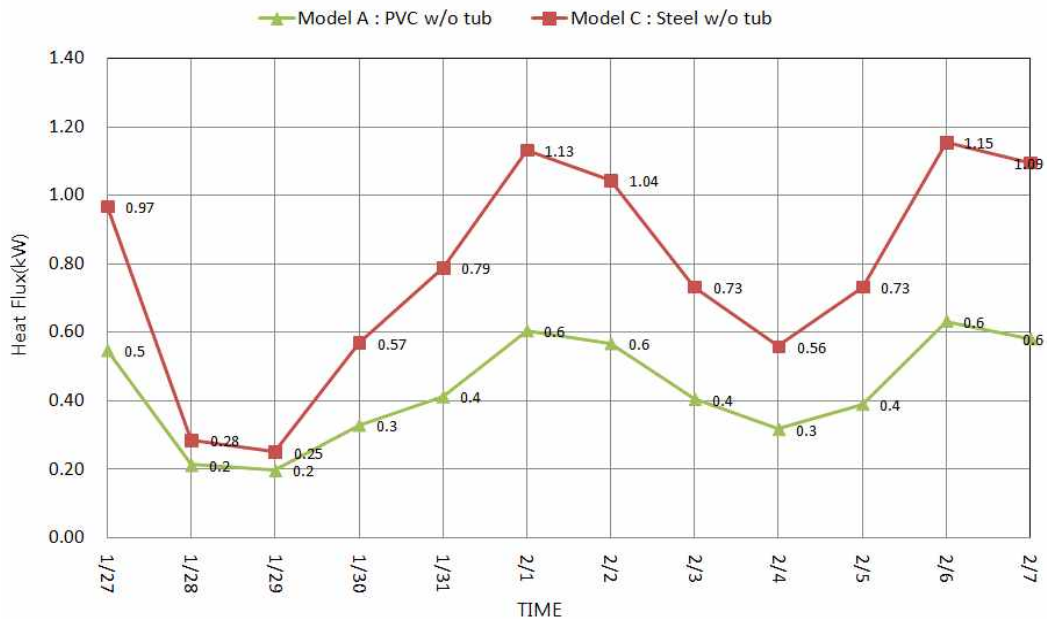
[그림 3-26] Model A, C 일별 Heat Flux 특성
