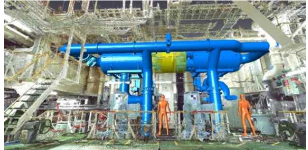
<독일 Fargo사의 PointSense S/W와 그리스 ARGO Navis Marine의 DWT Bulk carrier 선내 BWTS 리트로피팅>
