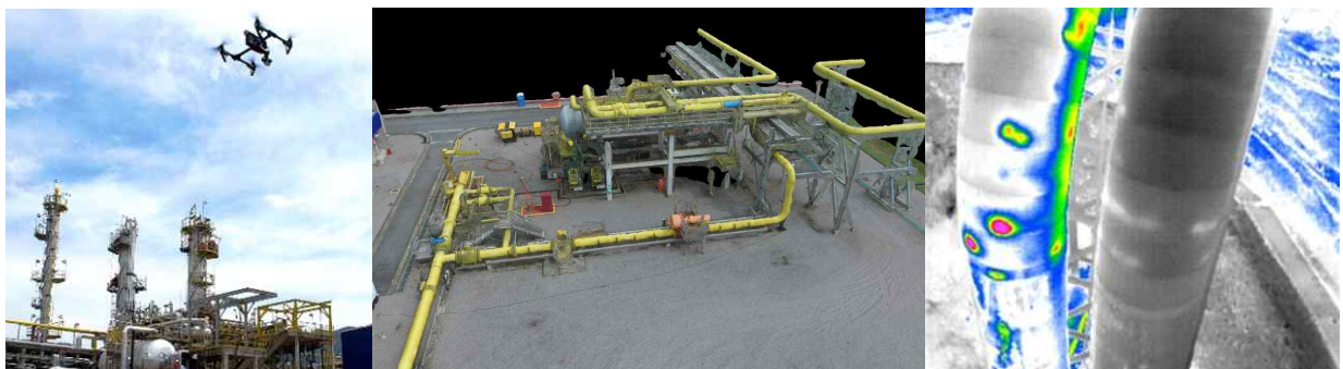
<브라질 PETROBRAS 가스 Plant의 2016년 Aerial Photogrammetric Survey와 가상 리트로피팅용 열화상 영상>
