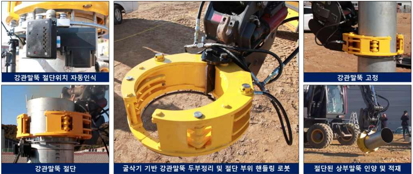
그림 3.23 굴삭기 기반 강관말뚝 두부정리 및 절단 부위 핸들링 로봇 시제품
