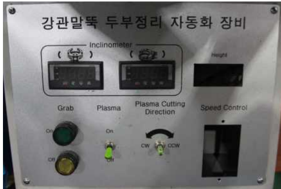
그림 3.18 강관말뚝 절단부 - 절단부 구동 장치
