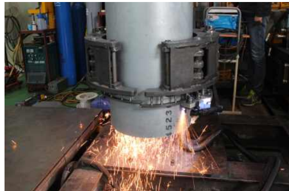
그림 3.19 성능분석을 위한 실험실 환경 내 테스트베드(Test-bed) 및 강관말뚝 절단부 성능분석
