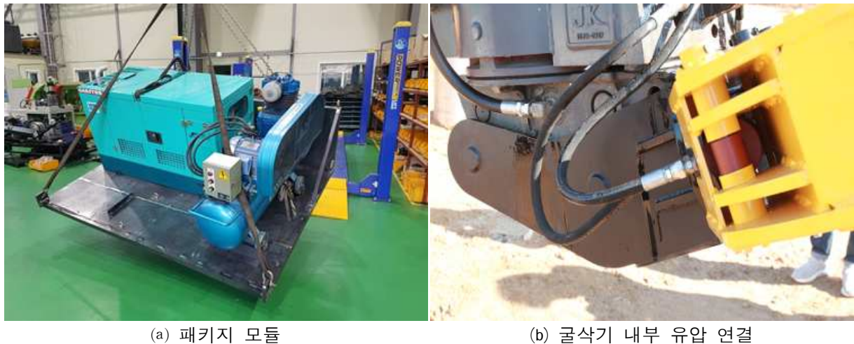
그림 3.24 굴삭기 기반 강관말뚝 두부정리 및 절단 부위 핸들링 로봇 시제품의 구성
