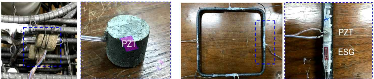
(c) 내장형 인터페이스 블록, 철근부착용 PZT 센서 설치
