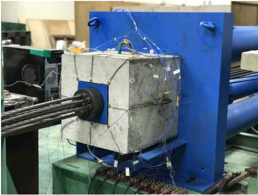
(d) 실험용 프레임에 거치된 텐던-앵커블록-콘크리트 정착부 예시 그림 2-1-5 콘크리트 정착부 모형 제작(핵심성과 2-① 목표달성㉠)
