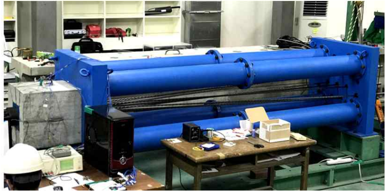
(d) 실험용 프레임에 거치된 텐던-앵커블록-콘크리트 정착부 예시 그림 2-1-5 콘크리트 정착부 모형 제작(핵심성과 2-① 목표달성㉠)
