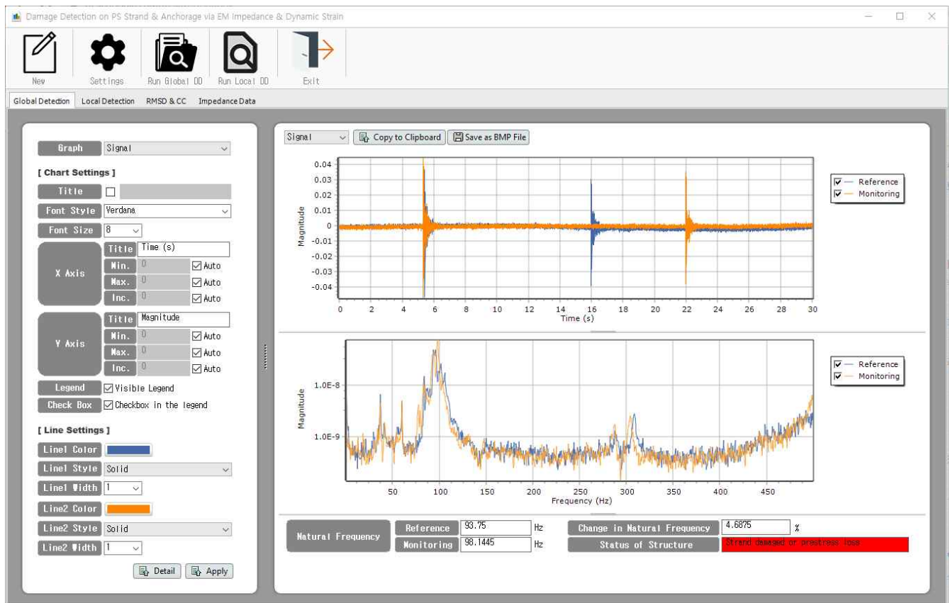
그림 2-2-4 강연선/정착부 파손감지 SW의 동적변형을 응답 및 전역적 구조상태 표시 화면
