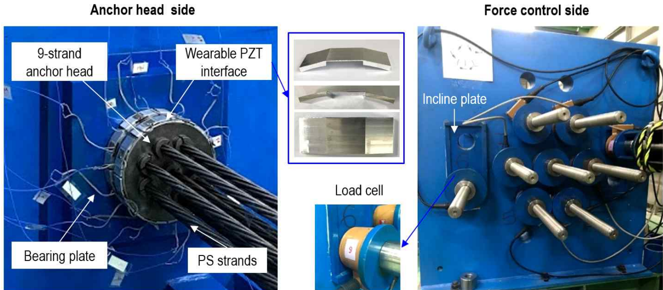
그림 2-1-15 앵커헤드용 웨어러블 인터페이스의 압전신호 계측 실험 셋업(핵심성과2-① 목표달성⑧)
