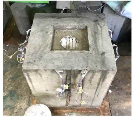
(c) 철근 콘크리트 양생
