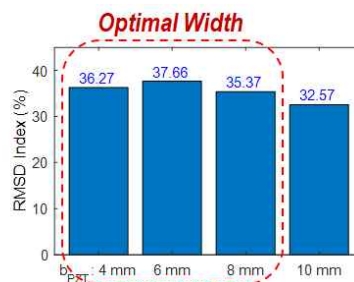
그림 1-3-9 손상 민감도 해석을 통한 PZT 센서의 최적 제원 선정
