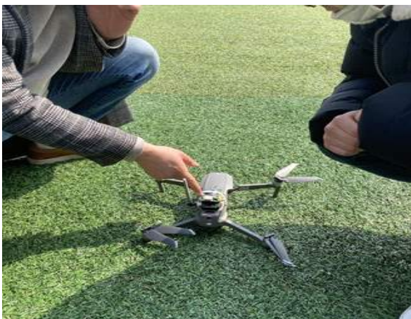
<메빅에 장착한 RFI 단말기 실증 테스트>
