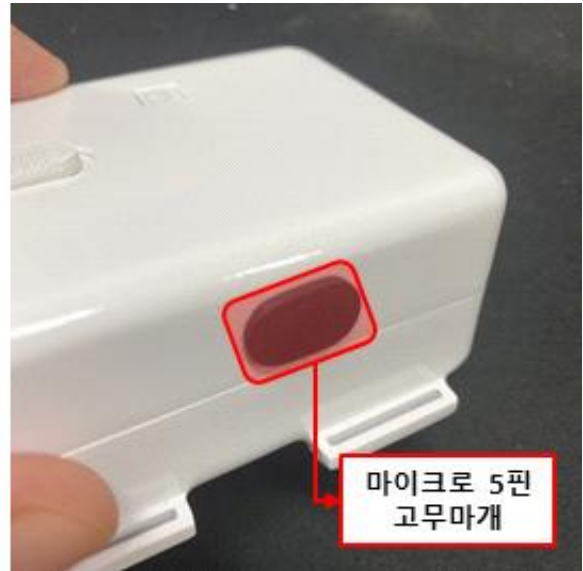
<단말기 O링 및 자체 설계 고무마개 실물 사진>
