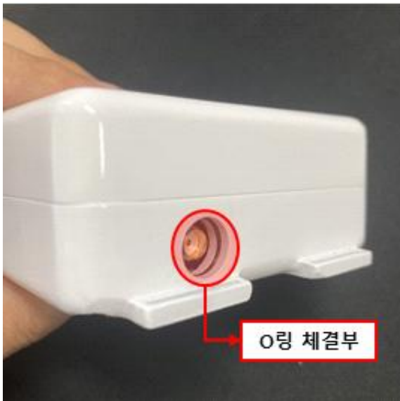
<단말기 O링 및 자체 설계 고무마개 실물 사진>
