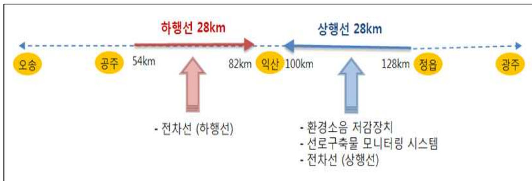
그림 2-18 400km/h급 인프라 시범적용 사업의 현장 시험설비 계획
