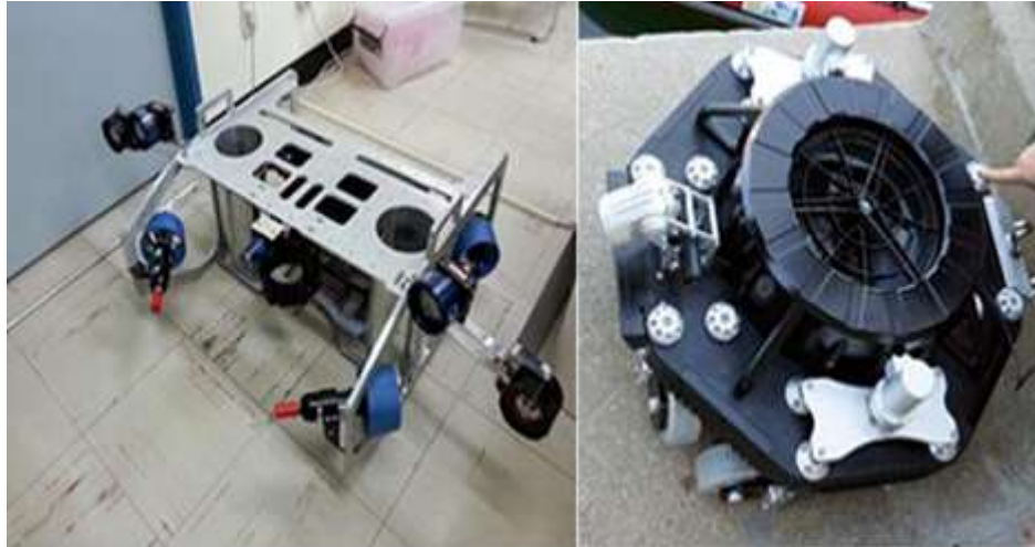
[그림 44] 광학카메라 및 소나 기반 수중구조물 점검시스템
