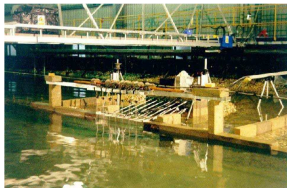
(b) 2007년 이탈리아 연구진이 수행한 수리모형실험 전경(Martinelli et al., 2007)
