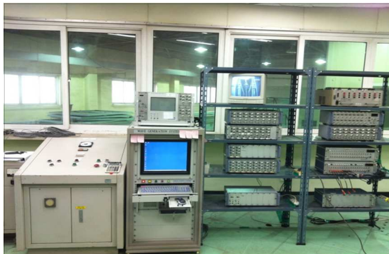
〈그림 71〉 조파 제어장치 및 Data 처리장치
