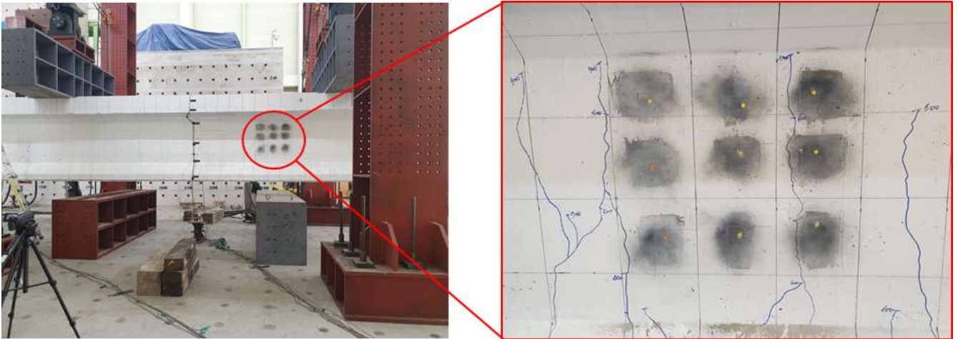
그림 109. 군성강교 실내 파괴실험 실험 모습
