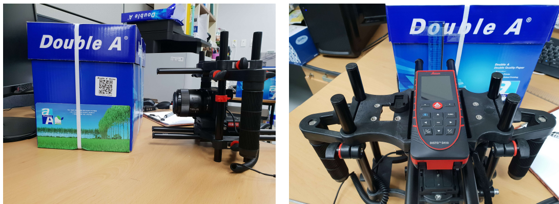
그림 72. 카메라 분해능, 촬영거리 확인용 실험
