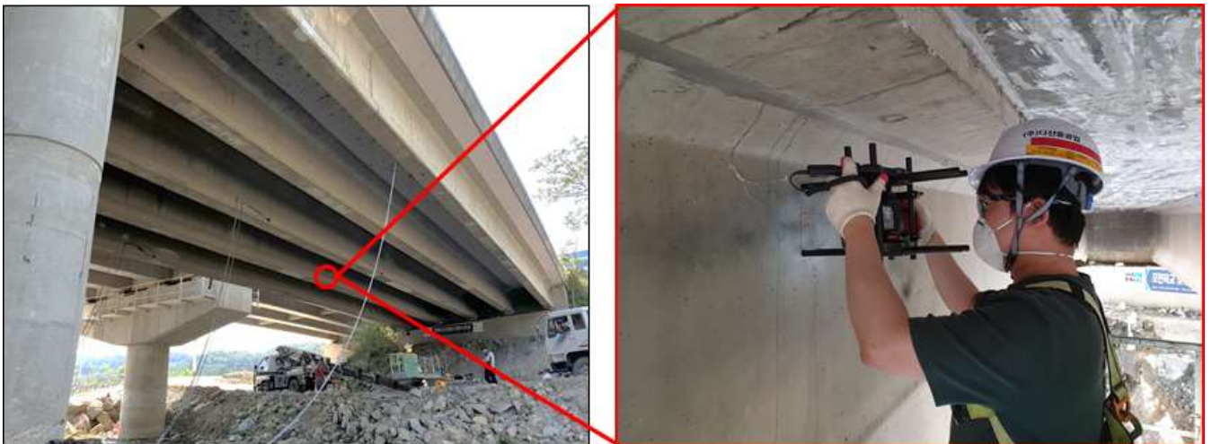
그림 108. 군성강교 응력계측 실험 모습
