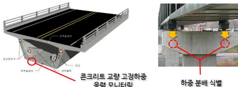
그림 3. 콘크리트 고정하중 응력계측 기법의 응용 예
