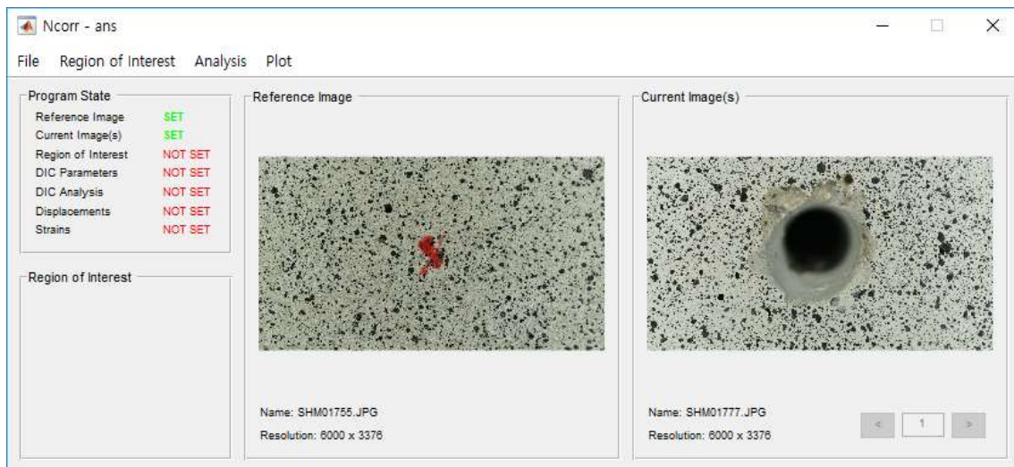
그림 16. Ncorr를 이용한 변위장 계산
