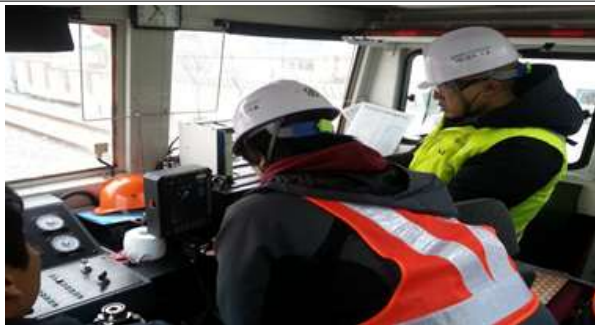
그림 72 ATP 차상장치 화면현시장치 시험
