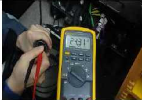
LCATP ↔ MMI RS485 통신 인터페이스 시험
