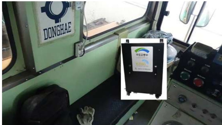
그림 82 선로관리처 모터카에 ATP 차상장치 설치 예제
