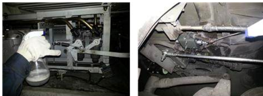
[그림 3.7.5 개발품 비눗물을 이용하여 누설검사]
