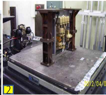
기관사제동패널 : X축 진동시험(1) → Y축 진동시험 (2) → Z축 진동시험(3)
