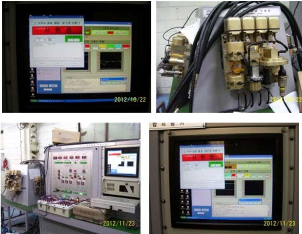
[그림 3.4.4 기관사 제동패널 및 공압보조패널 내구성 시험]
