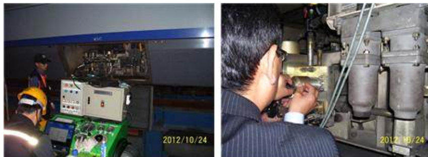
[그림 3.7.7 동력대차 제동패널 시험]
