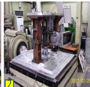
제동캘리퍼 : X축 진동시험(1) → Y축 진동시험 (2) → Z축 진동시험(3)
