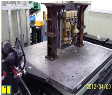
기관사제동패널 : X축 진동시험(1) → Y축 진동시험 (2) → Z축 진동시험(3)
