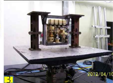
기관사제동패널 : X축 진동시험(1) → Y축 진동시험 (2) → Z축 진동시험(3)
