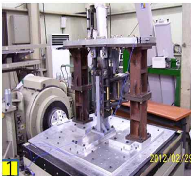
제동캘리퍼 : X축 진동시험(1) → Y축 진동시험 (2) → Z축 진동시험(3)
