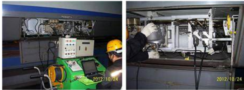
[그림 3.7.6 객차대차 제동패널 시험]
