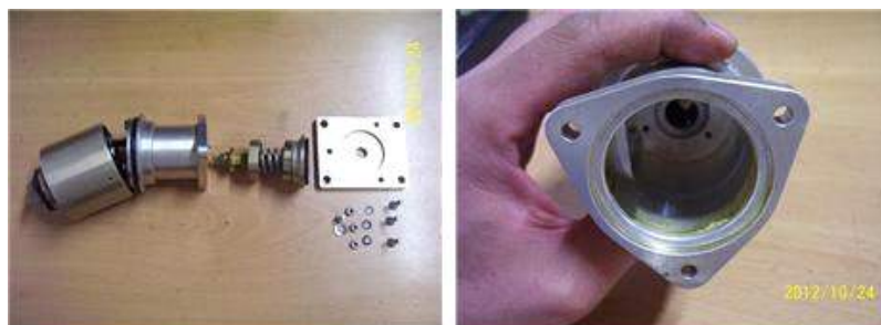
[그림 3.7.13 비상감지압력스위치 분해 및 하우스 내부]
