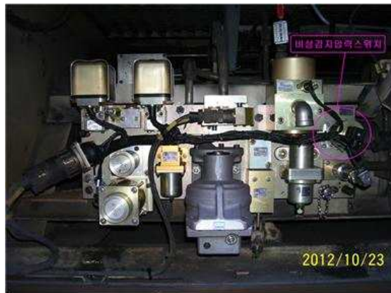
[그림 3.7.12 개발품 동력대차 제동패널 비상감지압력스위치]
