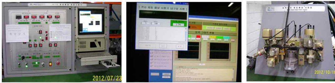
[그림 3.4.3 객차 및 동력대차 제동패널 내구성 시험]
