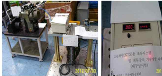
[그림 3.4.5 제동캘리퍼 및 주차제동실린더 내구성 시험]
