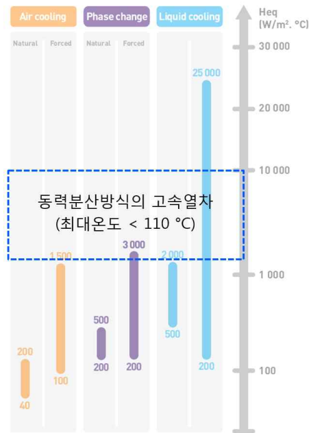
<그림 1-2-1> 열부하(Thermal Loads)에 따른 냉각방식 적용 예시
