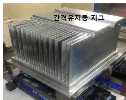
〈그림 2-3-21〉 호환성 확인용 시작품 2차 가공 방법
