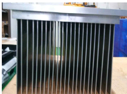
〈그림 2-3-22〉 호환성 확인용 히트싱크 제작 완료
