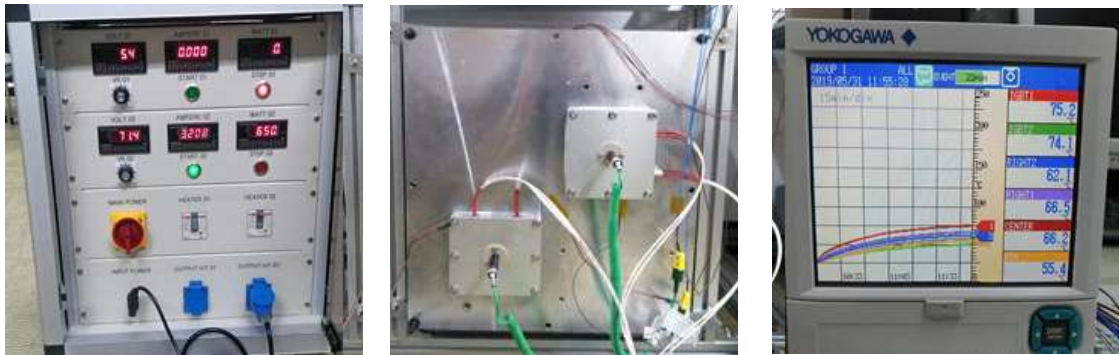
<그림 2-4-2> 실험실 단위 시험 장치 구성
