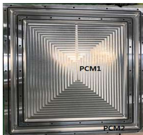
<그림 2-3-26> PCM 히트싱크 초도 시작품 제작 완료
