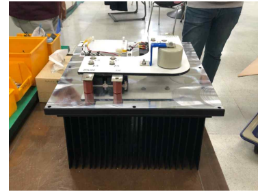
(c) IGBT stack 설치 완료
