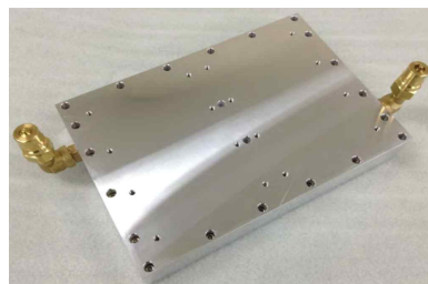
〈그림 1-2-7〉 전기기관차용 수냉각 스택 예시
