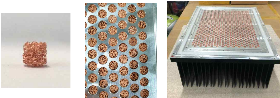
(a) copper foam 가공 (b) copper foam 설치 (b) 파라핀 주입
