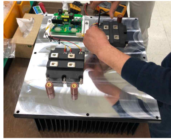
(b) IGBT stack 설치
