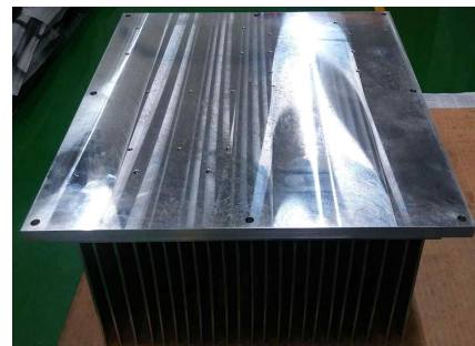
〈그림 2-3-22〉 호환성 확인용 히트싱크 제작 완료
