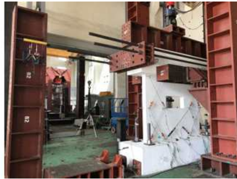
[그림 2.82] NBW의 LVDT 위치 및 설치 상황
