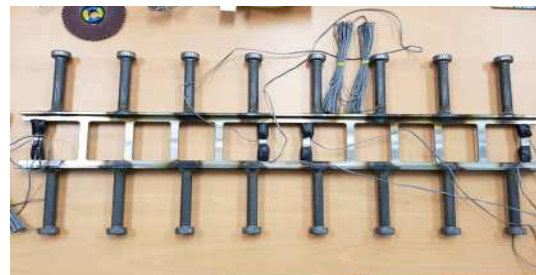
(b) 철판형 비내력벽 연결 시스템 철물 (스트레인 게이지 작업)
