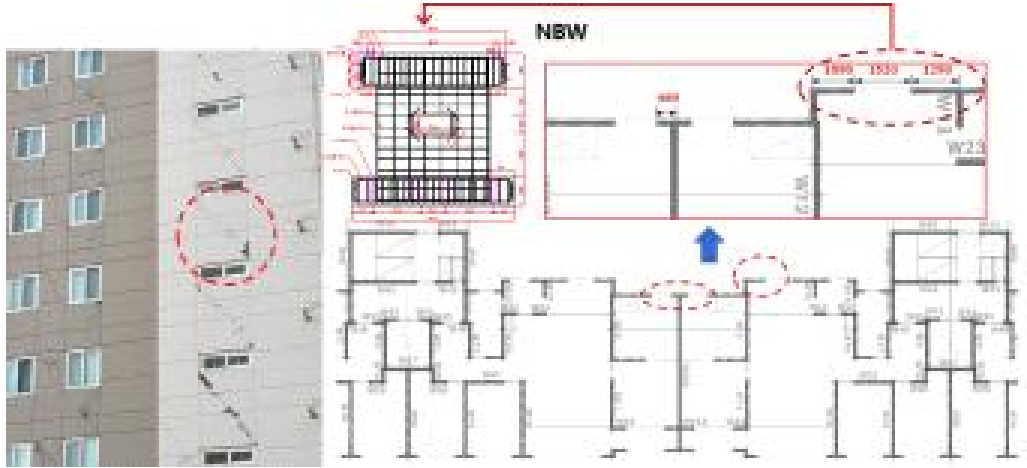
[그림 2.78] 포항지진(2017)으로 인하여 피해가 발생한 벽식 아파트
