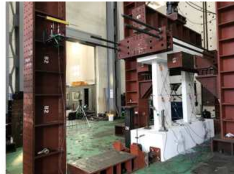
[그림 2.83] REF, DBW, SPW, HW의 LVDT 위치 및 설치 상황
