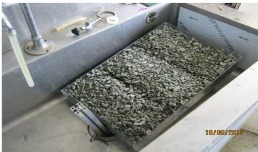
[그림 4-28] Lab Scale 살수여상(식생조)
