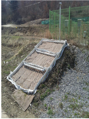
[그림 4-38] 시간 경과에 따른 3차 시설 및 비점오염처리 시설 살수여상(식생조) 변화 과정(pilot plant)
