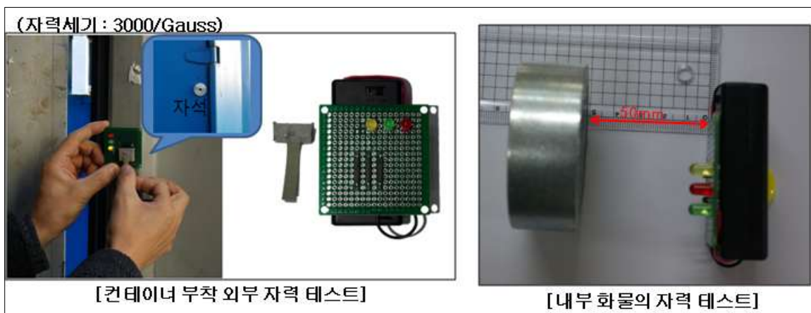
<그림 42> Reed Sensor의 오동작 테스트
