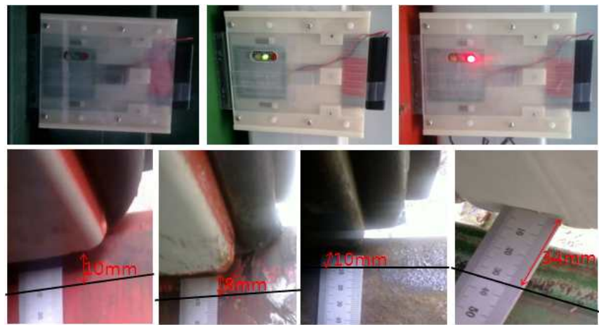
<그림 43> Reed Sensor의 컨테이너 부착 테스트 사진
