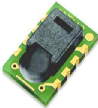
<그림 40> ConTracer에 적용한 온도/습도 센서와 외부 노출용 방수캡
