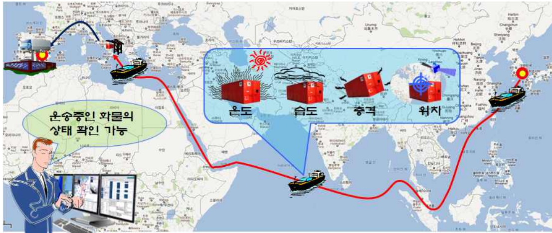
<그림 39> 글로벌 화물추적 장비의 운용중 온/습도, 충격 상태 감지 개념도
