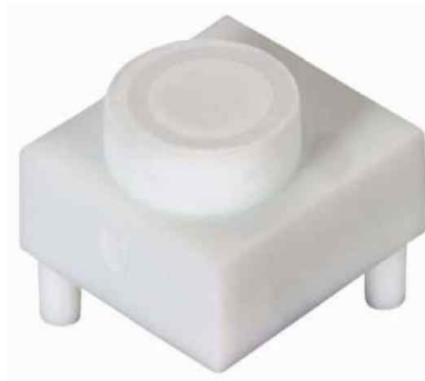
<그림 40> ConTracer에 적용한 온도/습도 센서와 외부 노출용 방수캡
