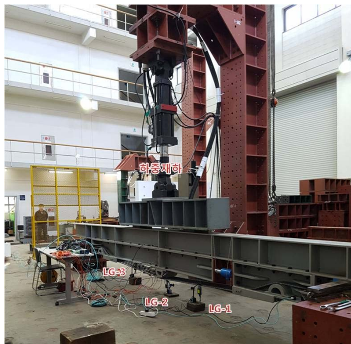
그림 3-8-2(6). 긴장력과 외력에 따른 띠장 처짐 실험 전경 및 Linear Gauge 부착 위치
