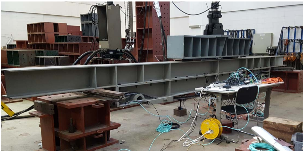
그림 2-5-2(2). 강연선 장력 - UTM 하중 띠장 처짐 시험
