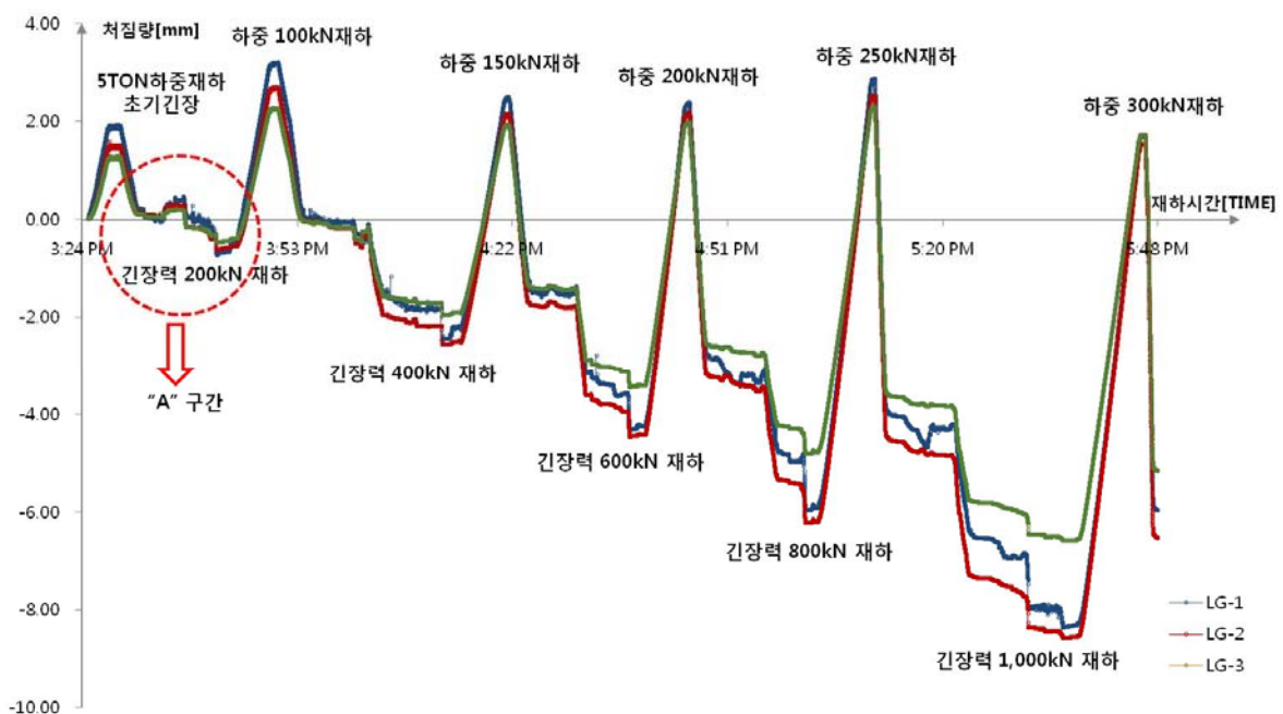
그림 3-8-2(7). 긴장력 유압과 재하하중에 의한 처짐량 분석
