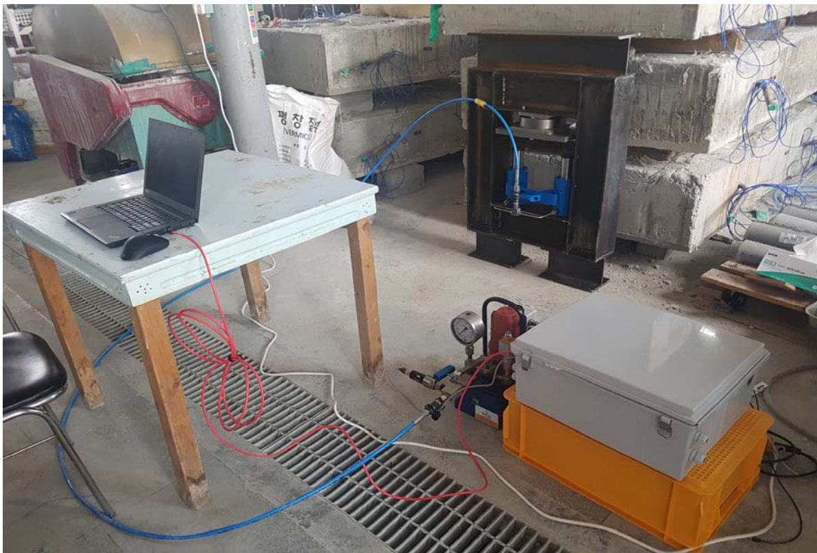
그림 2-10(2). 유압 제어 시스템 시험기관 성능시험 실제 사진
