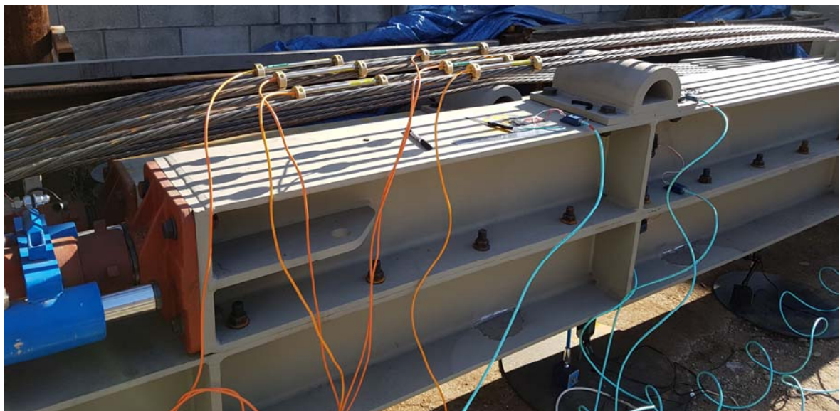
그림 2-5-1(2). 강연선 장력 - 띠장 처짐 시험
