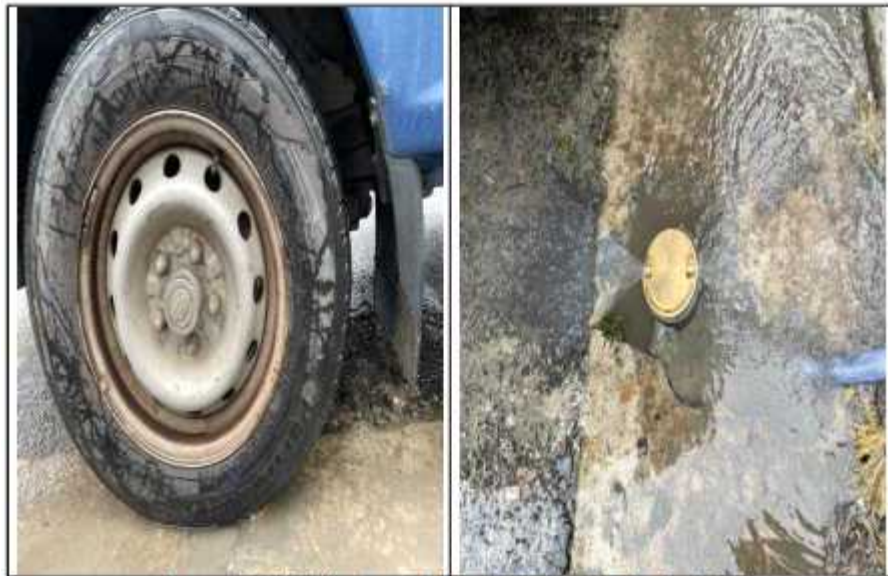
<그림 5> 자동차 통과 후 노즐밸브 작동 이상 유·무 차량 통과 후
