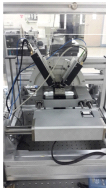
그림 28. Fico 회사의 Zomega THz 반사율 측정장비 (좌: 레이저 이동경로 셋업, 우: 레이저 입사 및 디텍터 장치)
