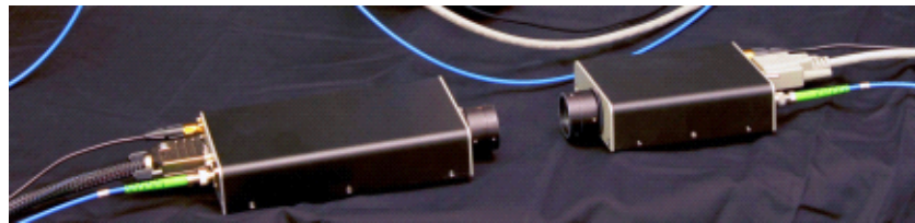
그림 46. 광섬유 펄초 레이저 시스템에 기반한 THz 발생기 및 검출기, 모듈화로 이루어져 있기 때문에, 포터블하고, 원하는 측정 대상에 쉽게 접목할 수 있는 장점이 있다.
