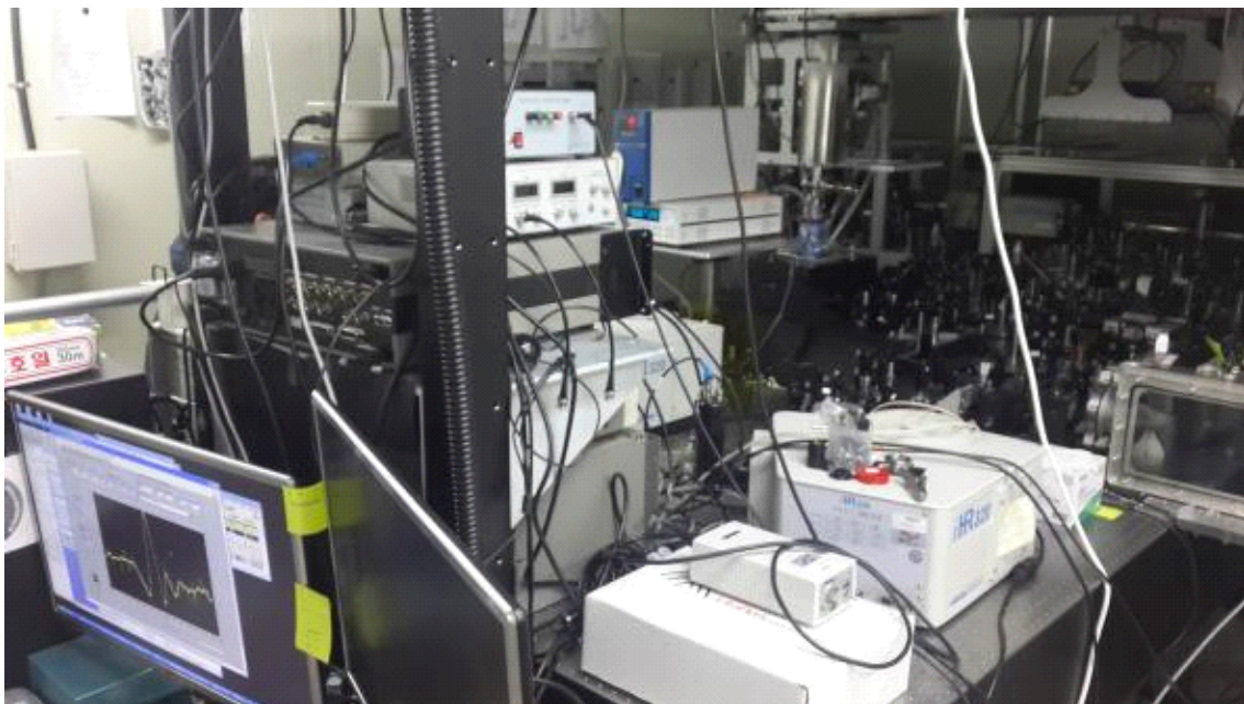
그림 21. 실험실에서 지반매질의 동결상태에서의 THz laser 투과실험을 하는 모습.
