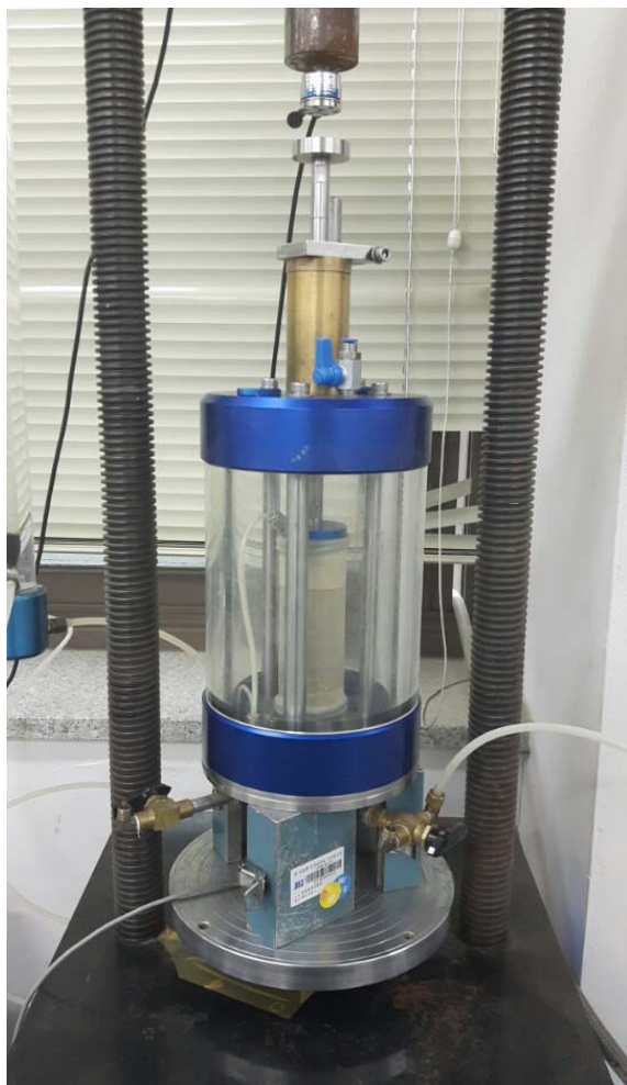
그림 46 불포화 일축압축시험기(상)와 시험기의 모식도(하)
