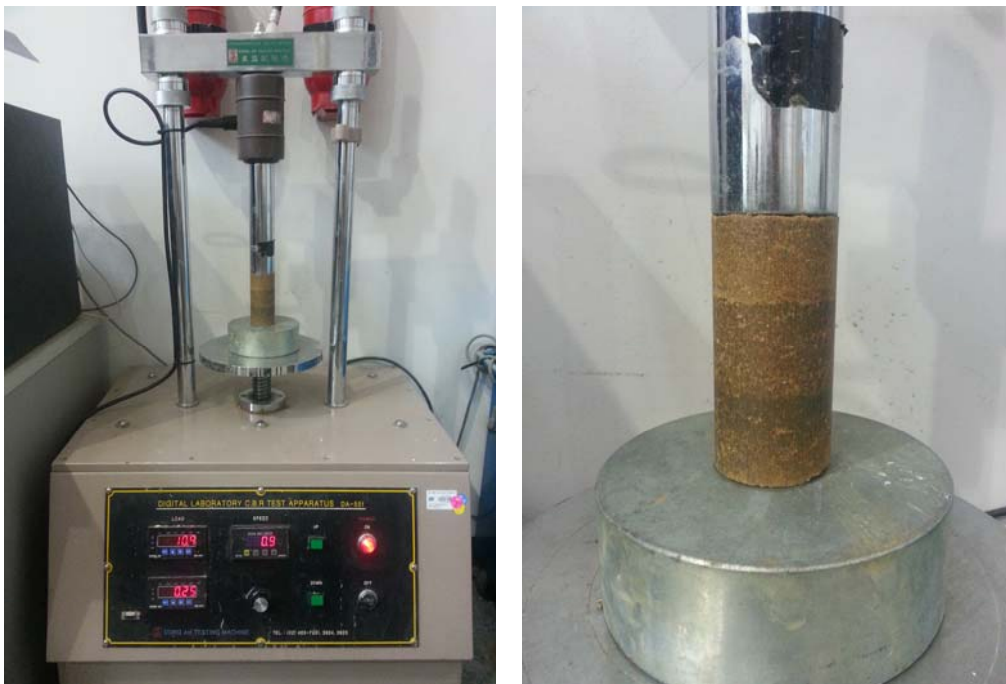
그림 40 일축압축시험기(좌)와 시료가 압축을 받고 있는 모습(우)
