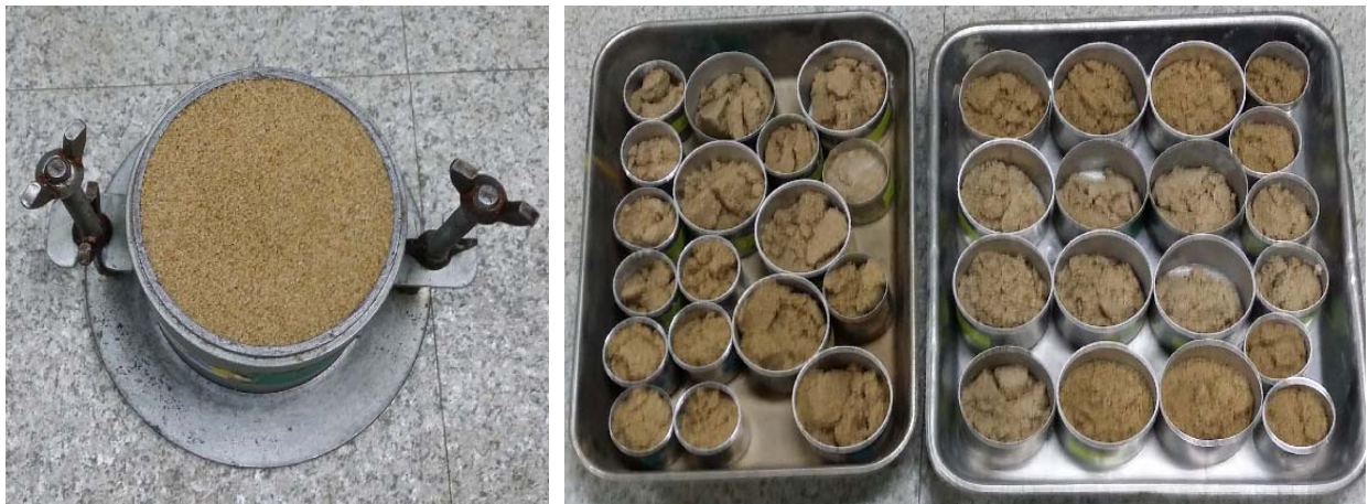
그림 30 다짐 후 몰드(좌)와 함수비 측정(우)
