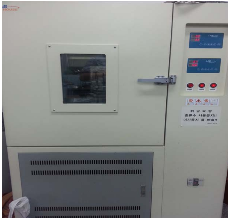
그림 25 동결 및 융해환경 조성에 사용된 냉동채임버(상)와 항온항습기(하)
