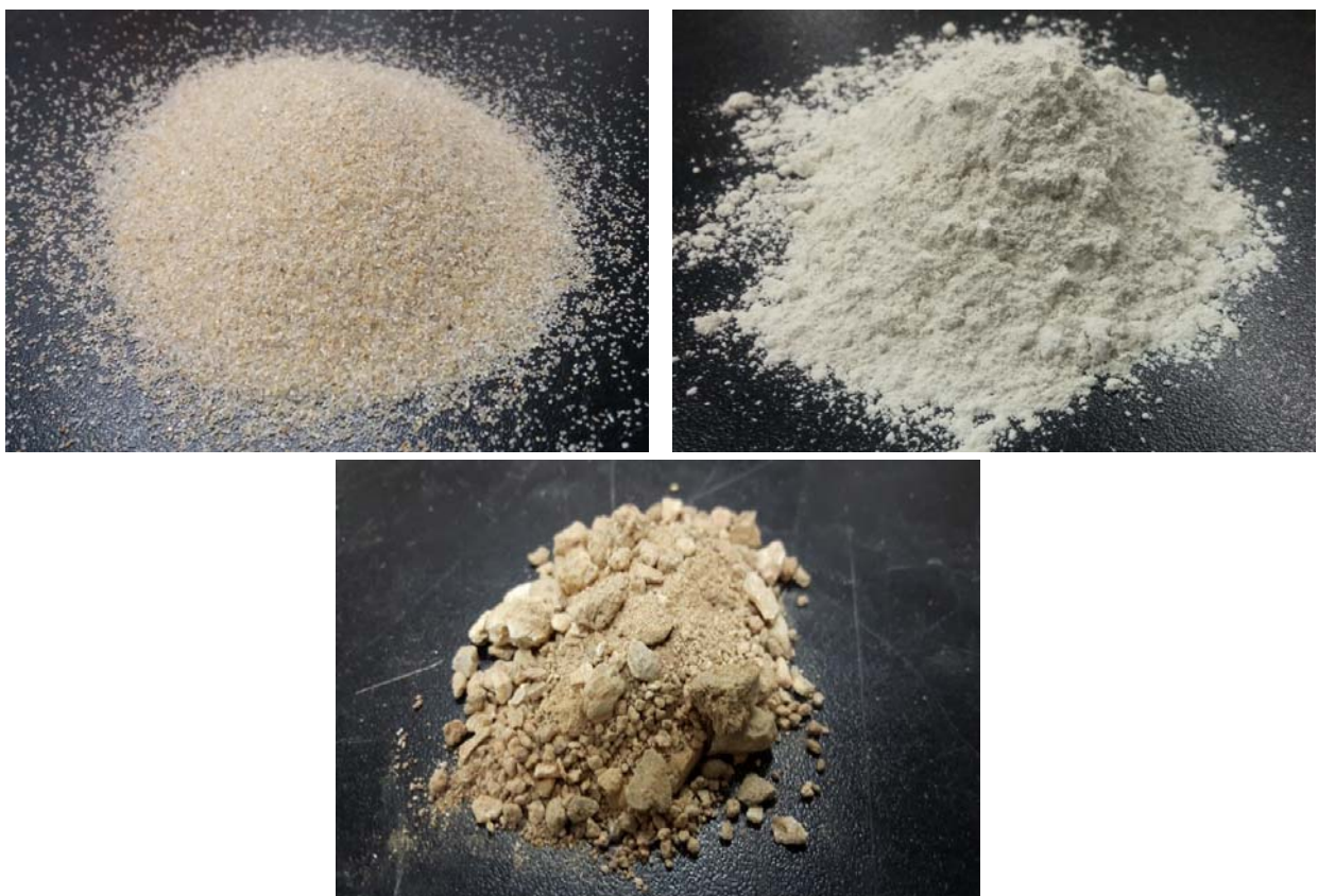
그림 22 본 연구에 사용된 주문진 표준사(좌), 카올리나이트(우), 풍화토 고양A(하)시료
