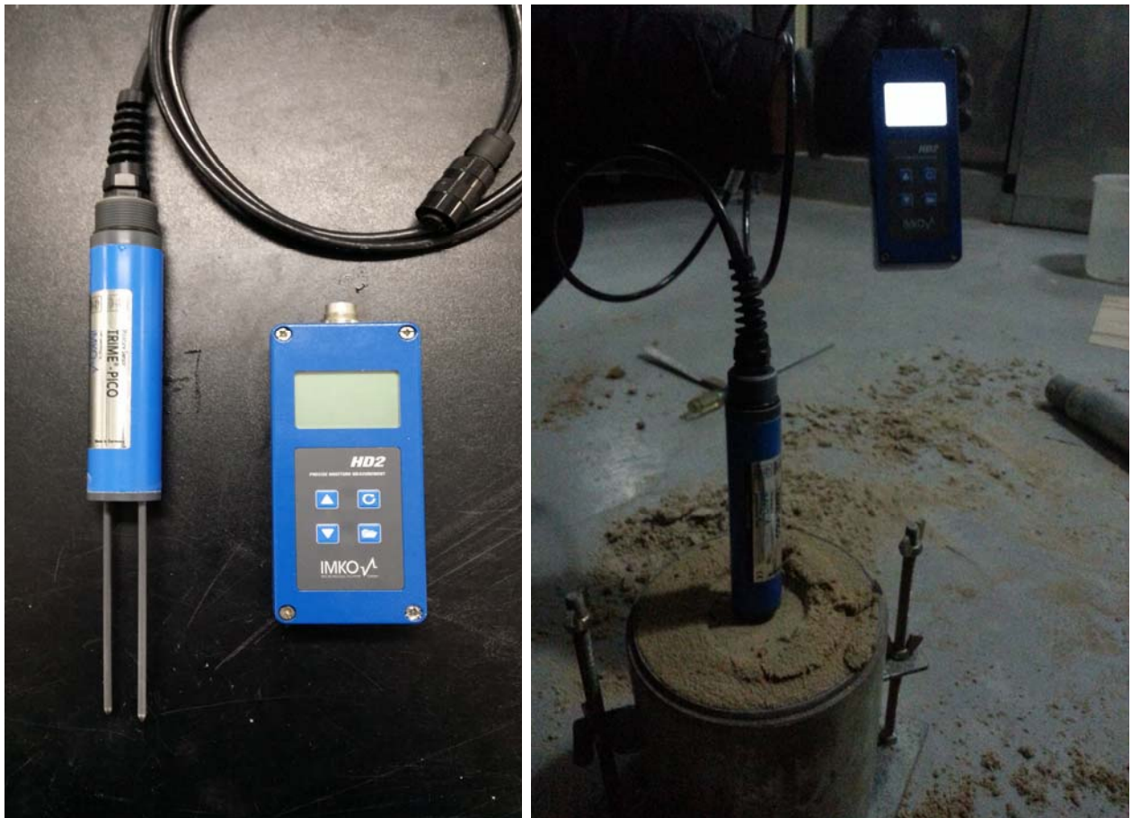
그림 38 TDR장비(좌)와 TDR장비를 이용해 부동수분 측정하는 모습(우)
