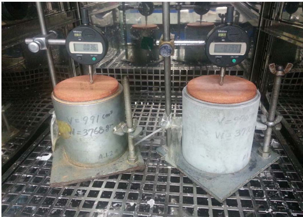
그림 51 동결된 시료를 항온항습기에서 용해시키면서 체적변형을 측정하는 모습
