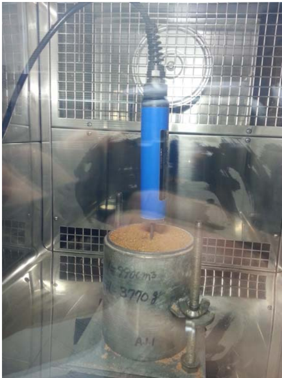
그림 26 냉동제임버(좌)와 상온(우)에서 부동수분을 측정하는 모습
