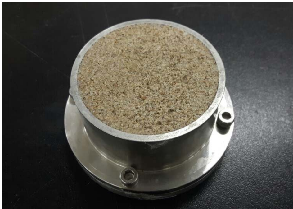
그림 42 세립분 15%를 함유한 모래시료를 성형한 Brass ring
