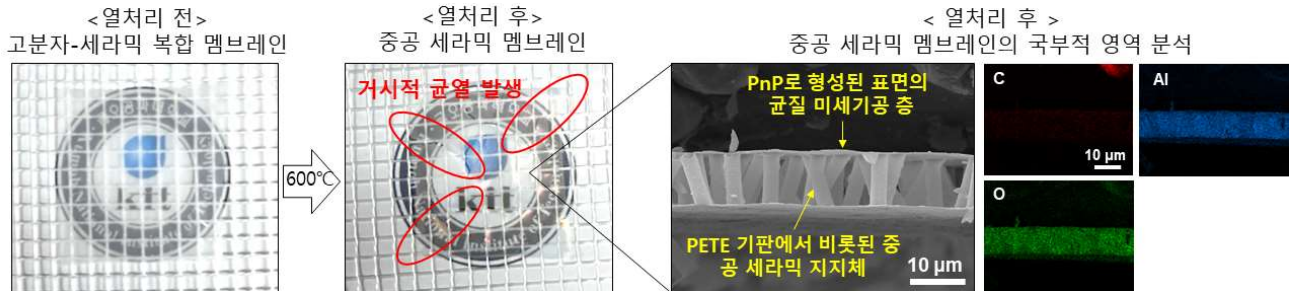
그림 30. 고온 열처리에 의한 템플릿 제거 과정에서 발생하는 거시적 균열 및 국부적 영역 분석.
