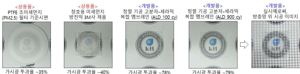
그림 28. 본 연구개발을 통해 개발된 고분자-세라믹 복합 멤브레인과 상용품의 투광성 비교.
