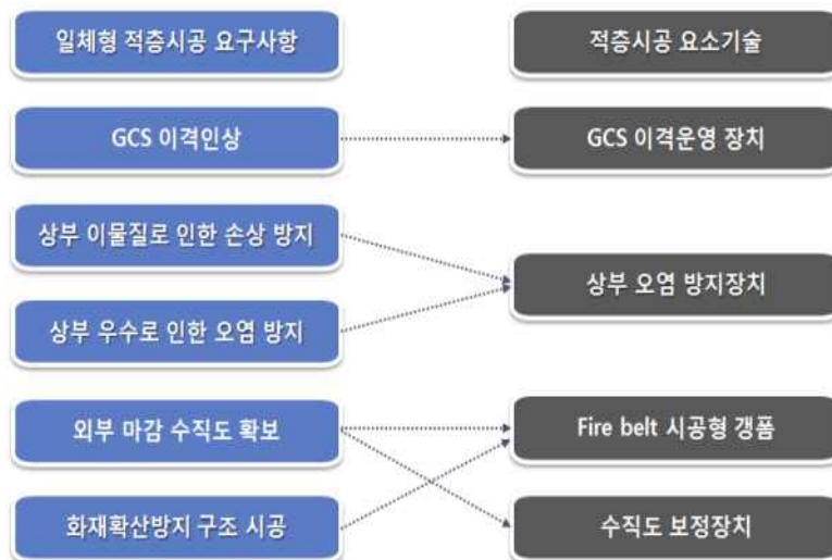
[그림 9] 외단열 적층시공 가설시스템 기본 설계 요구사항
