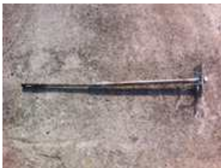
[그림 22] 폼타이-원터치볼트 체결 모습
