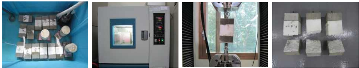
[그림 26] 부착강도 시험 모습
