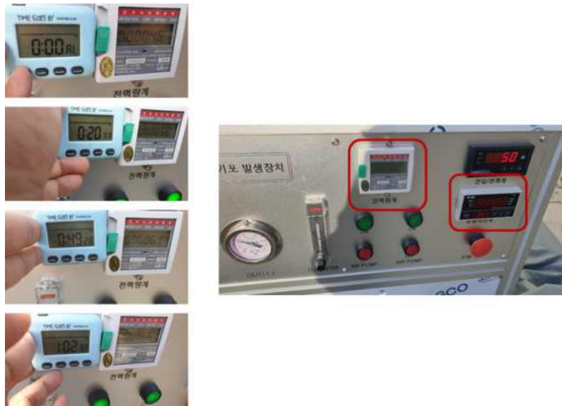
<그림 83. 미세기포 발생장치로부터 소모전력량과 유량적산계 측정>
