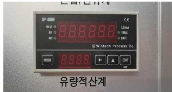
<그림 62. 세척장비 장착된 전력량계 및 유량 전산계>
