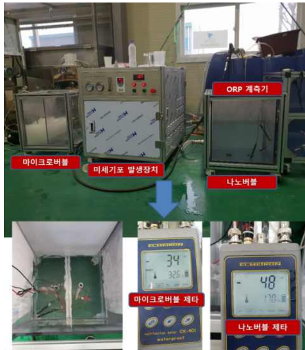
<그림 69. 나노버블수의 표면전위 측정을 위한 제타전위 측정 및 확인>
