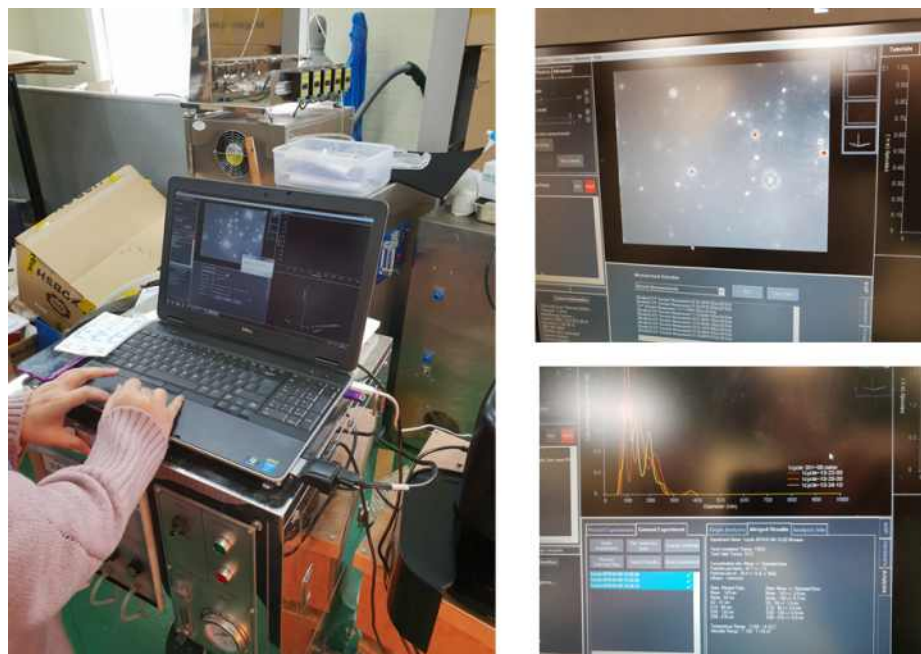
<그림 73. 나노사이트(Nanosight)를 이용한 나노버블 직경을 측정>
