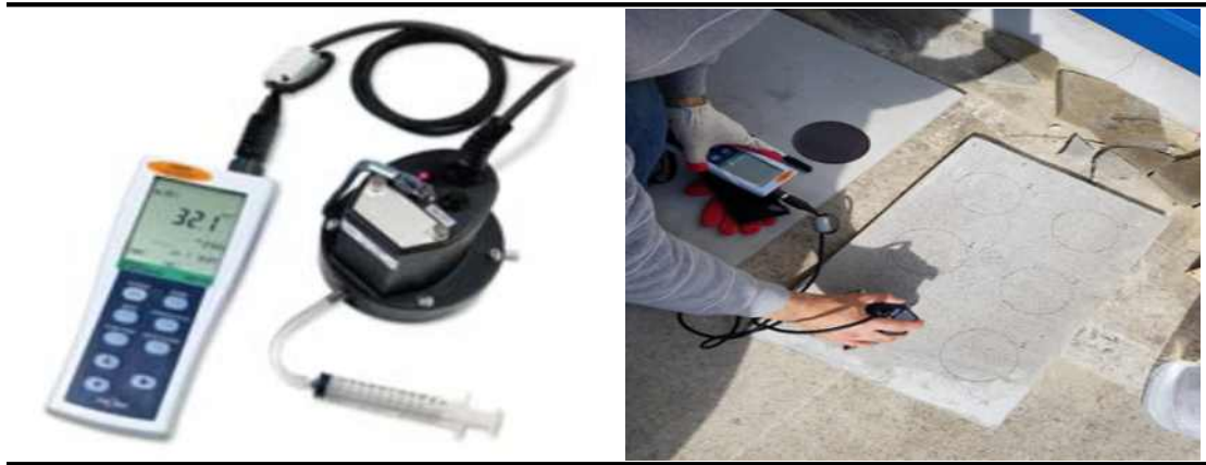
<그림 90. SSM-21P 염분측정기기 및 미세기포 세척장비 염분제거율 평가 실험사진>
