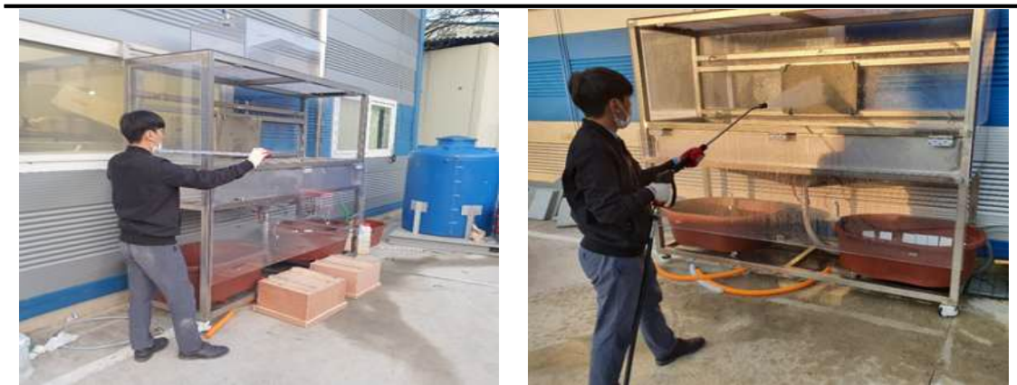
<그림 91. 미세기포 세척장비 거리, 압력별 염분제거율 평가 실험사진>
