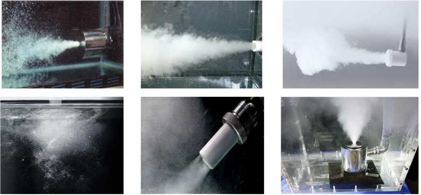
<그림 9. 다양한 방법에 의한 미세기포 생성과정>
