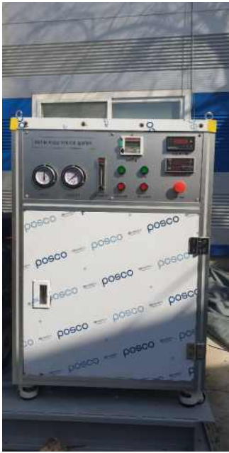
<그림 56. 2차년도 4HP급 80L/min 규모의 미세기포(세척장비) 설계도면 및 제작>
