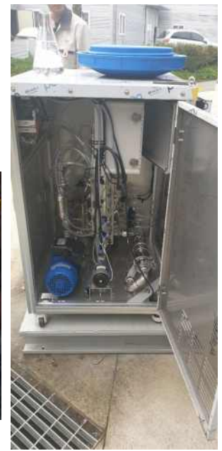
<그림 56. 2차년도 4HP급 80L/min 규모의 미세기포(세척장비) 설계도면 및 제작>
