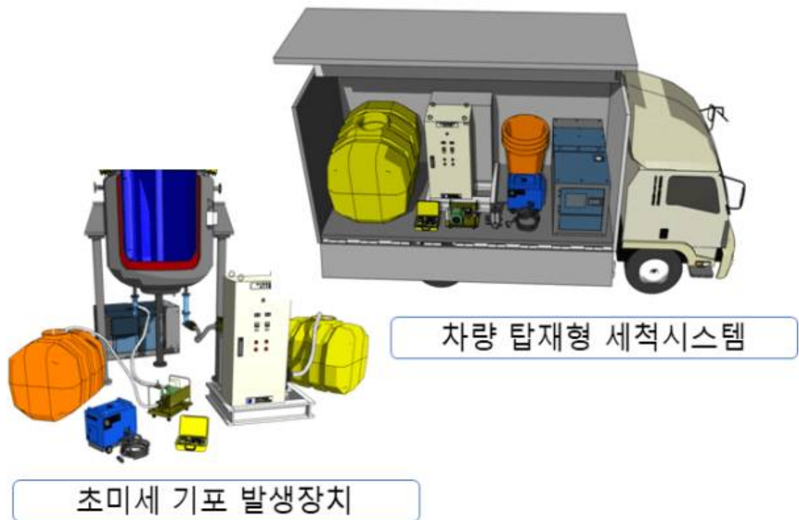
<그림 32. 서일본 고속도로 주식회사와 연계한 Ligaric사(일본)의 초미세기포 세척장치 설계도>
