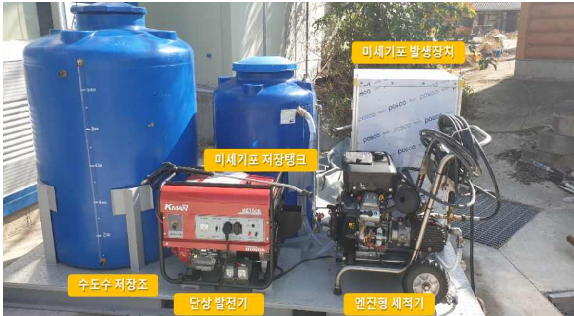
<그림 65. 2차년도 차량 탑재형 4HP급 80L/min 규모의 미세기포(세척장비)>
