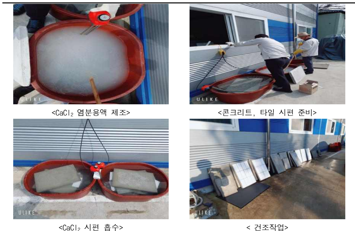
<그림 89. 콘크리트, 타일 염분코팅 작업>
