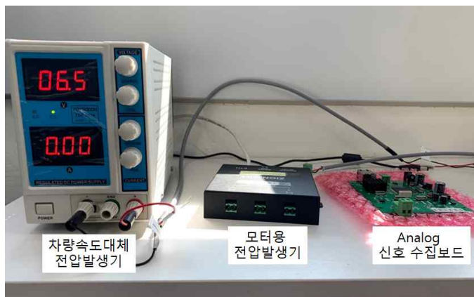
▲ 가변 전압 발생기를 사용한 실내 테스트
