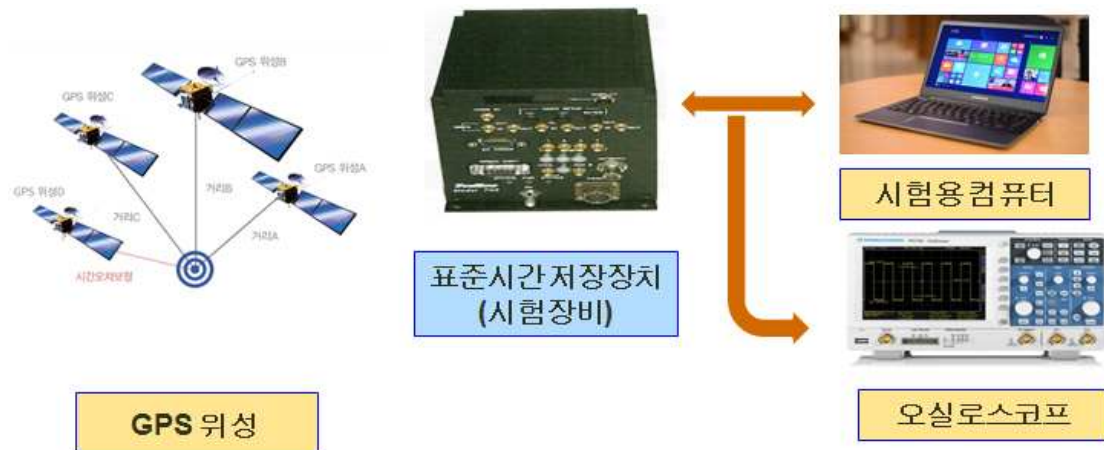
(그림 2-27. 시간부호 발생기 시험장비 구성(예))
