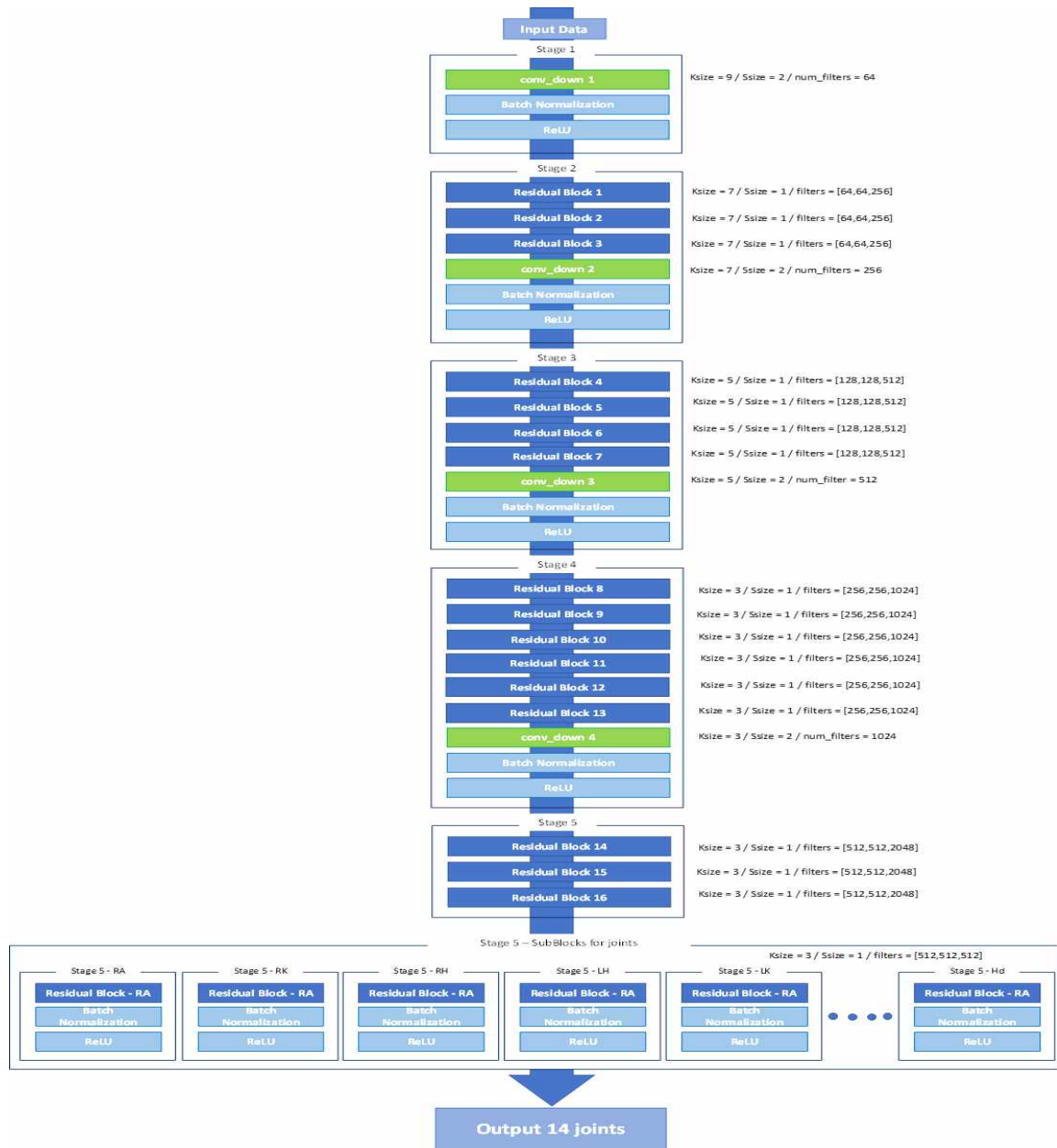
(그림 2.14) 여러 단계(stage)의 Deep Neural Network를 적응하여 joint 예측 정확도를 높인 사례
